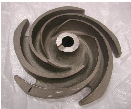
Slika 1. Ulitek »sesalna turbina«
