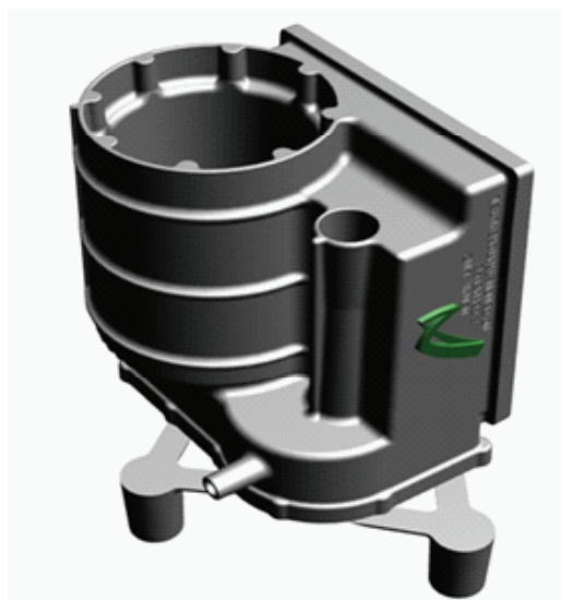
Slika 3. Enodelni liti demonstrator ohišja, zasnovan za postopek nizkotlačnega litja (LPDC)
