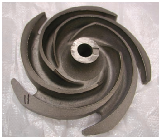
Slika 1. Ulit strojni del – sesalna turbina
