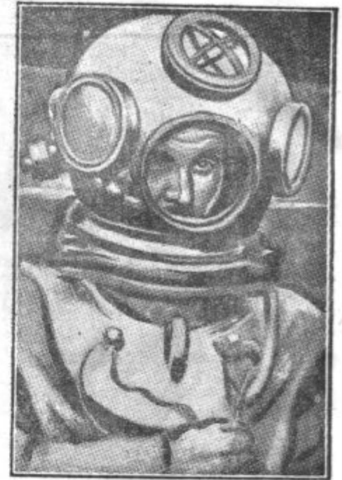
Z radijem v morski globini. Slika kaže morskega potapljača, v čigar čeladi je oddajna postaja za radio. Potapljača so slišale govoriti vse radio-postaje v Hamburgu in okolici.
