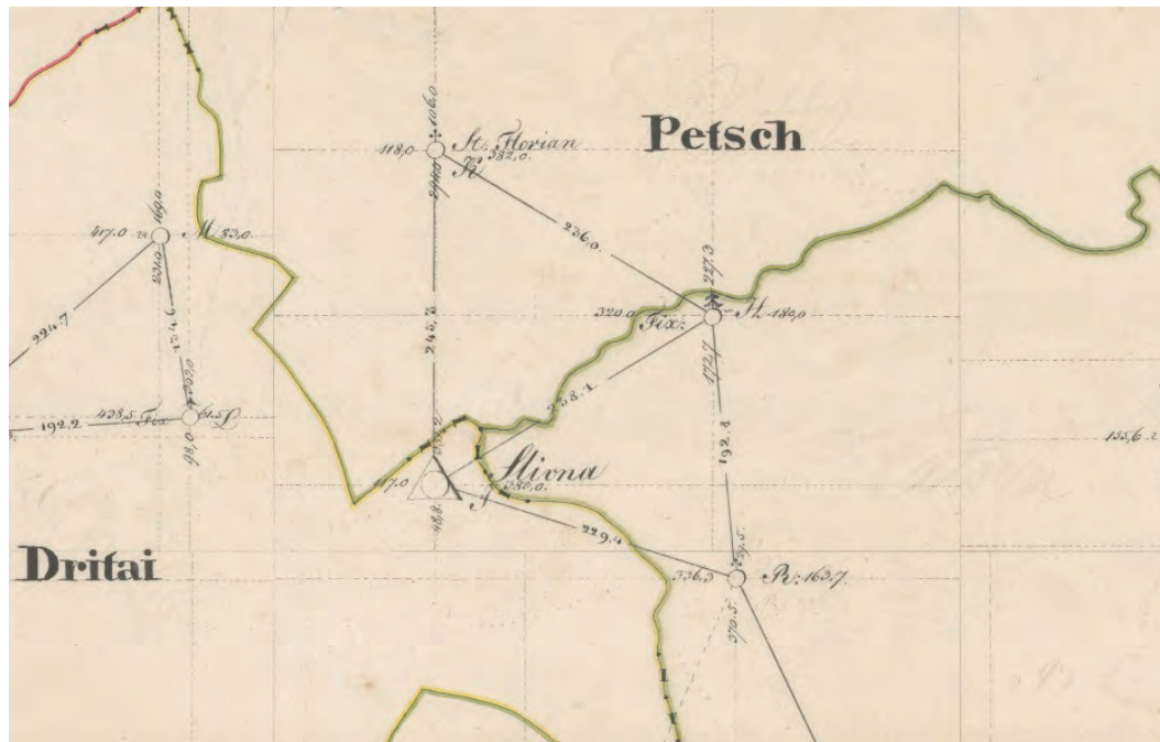
Slika 6: Izsek iz trigonometričnega lista v merilu 1 : 28.800 s triangulacijsko mrežo za območje okrog numerične trigonometrične točke Slivna pri Vačah (Arhiv Republike Slovenije, SI AS 177).
