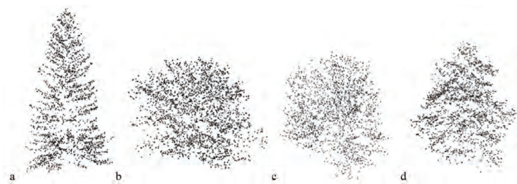
Slika 1: Krošnje dreves v laserskem oblaku točk z gostoto 15 točk/m 2 : a) smreka, b) oreh, c) jesen, d) lipa.
