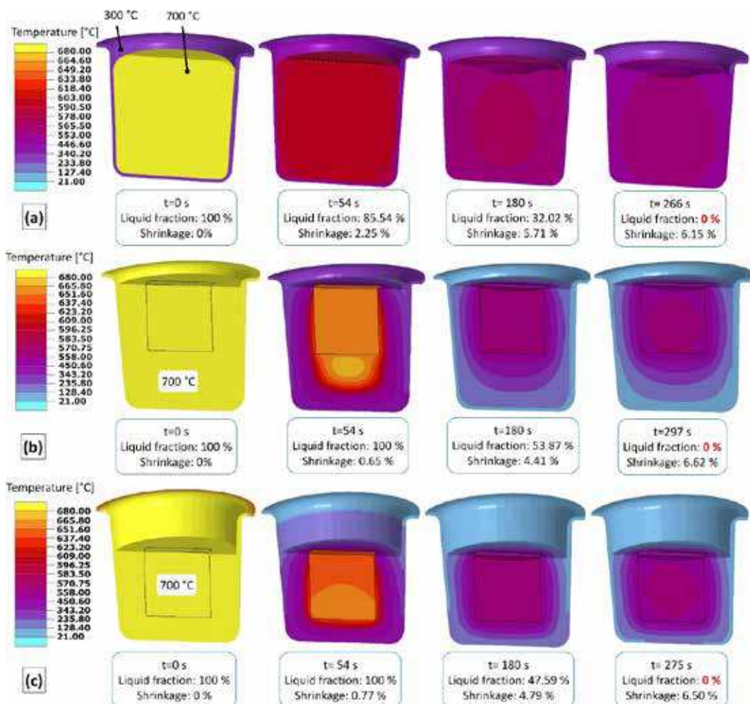
Slika 6. Prečni prerez porazdelitve temperature glede na simulacije strjevanja (a) tradicionalnih in (b,c) pretaljenih vzorcev RPT v različnih fazah procesa strjevanja. (b) predstavlja primer, ko je bilo za tališno sredstvo uporabljenih 55 g in (c), ko je bilo uporabljenih 30 g kremenčevega peska
