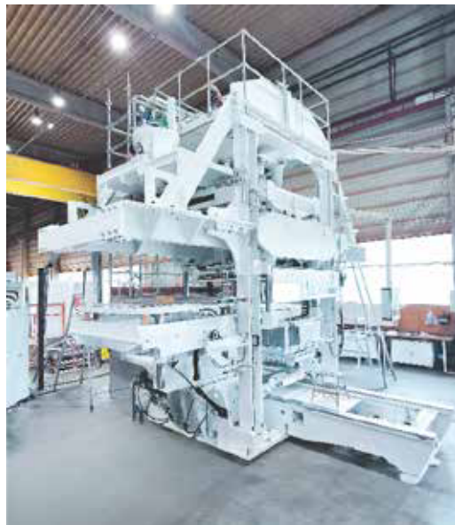
Slika 1. Stroj za izdelavo jeder: Učinkovit in prilagodljiv: Sodobni stroji za izdelavo jeder ostajajo osrednji steber hibridne proizvodnje jeder
