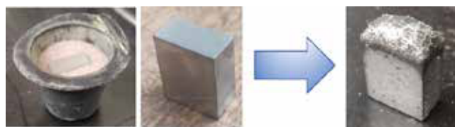
Slika 5. Ohranjanje oblike med pretaljevanjem in strjevanjem pod zmanjšanim tlakom
