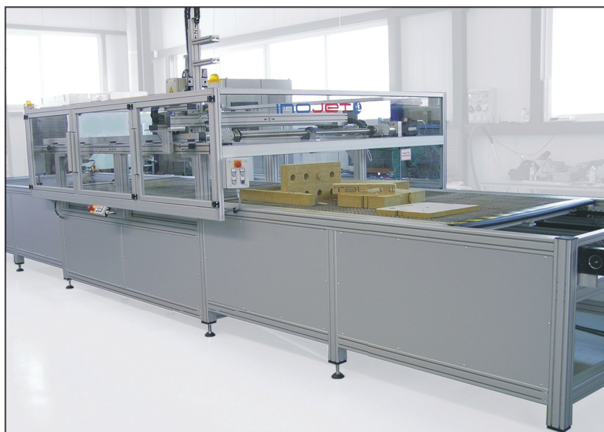
Slika 1. INOJET – portalna izvedba z dvostransko pomično mizo
