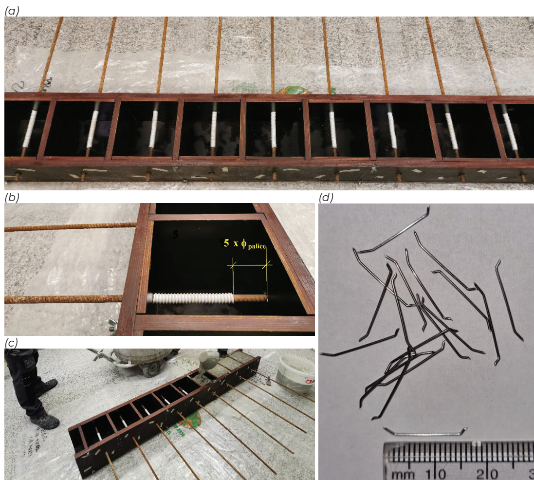
Slika 1. Prikaz izdelave preizkušancev za izvedbo preiskave izvlečne sile F_{izvl} in fotografija uporabljenih vlaken v mikroarmiranih betonskih mešanicah.
