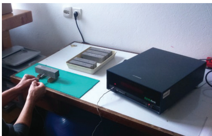
Slika 6 • Določanje »dinamičnega« elastičnega modula z GindoSonicom (levo) in določanje upogibne trdnosti (desno).
