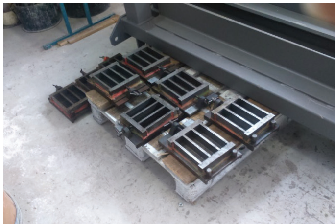
Slika 5 • Priprava kalupov (levo) in vgrajena mešanica MIX 5 (desno) na Katedri za preskušanje materialov in konstrukcij na UL FGG.
