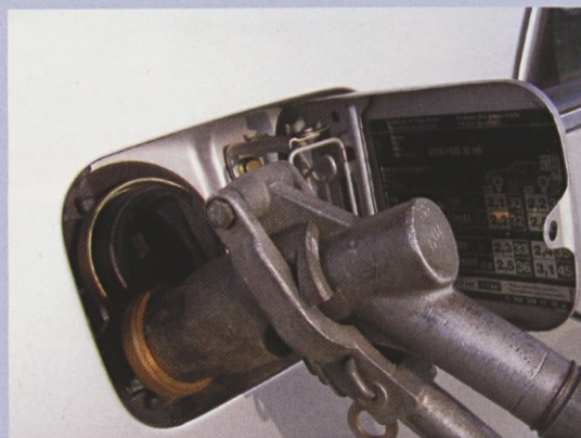
Slika priklučene polnilne pištole. Mesto za polnjenje avtoplina je ob tistem za točenje bencina ali dizelskega goriva.
