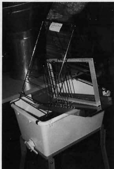
Novost delavnice čebelarske opreme Rakovec iz Ljubljane je bilo tudi dodatno stojalo za medene sate na koritu za medene pokrovice.
