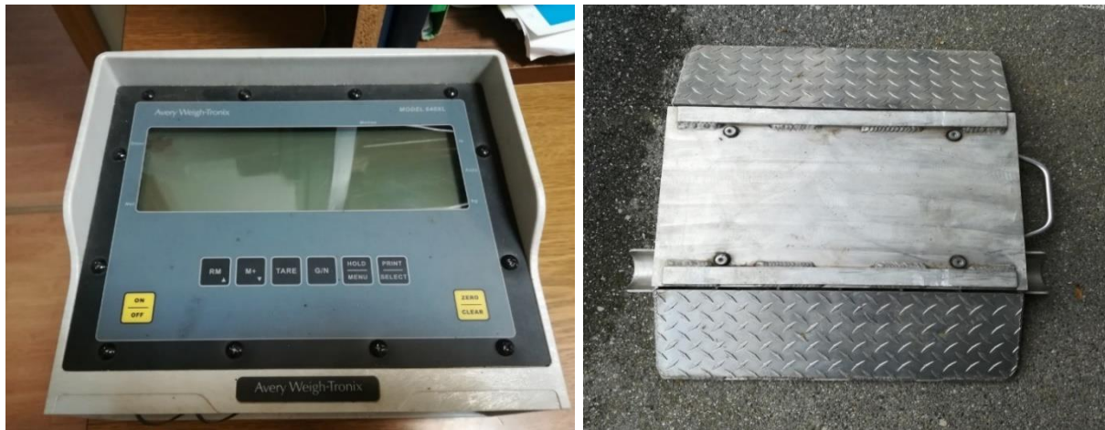
Slika 67: Tehtnica, uporabljena za tehtanje traktorja (levo), merilna plošča tehtnice Avery Weigh-tronix (desno)
