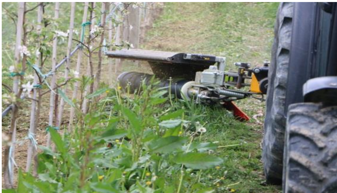
Slika 98: Orizzonti - vrstna kosilnica z nitkami-dolge nitke.
