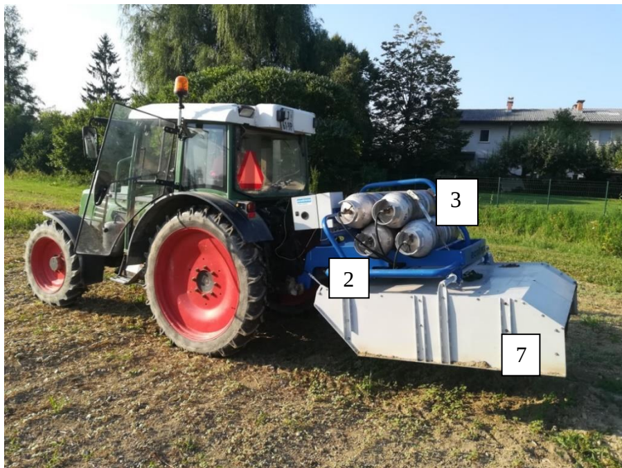
Slika 65: Stroj za ožiganje Ecobrena (2 – osnovno ogrodje, 3 – jeklenke s propanom, 7 – zaščitna pločevina; foto: Vučajnk F., 2019)
