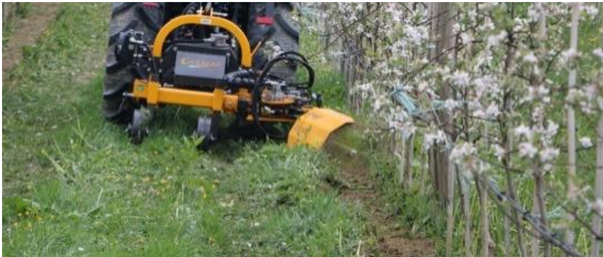
Slika 28: Orizzonti-vrstna kosilnica z nitkami.
