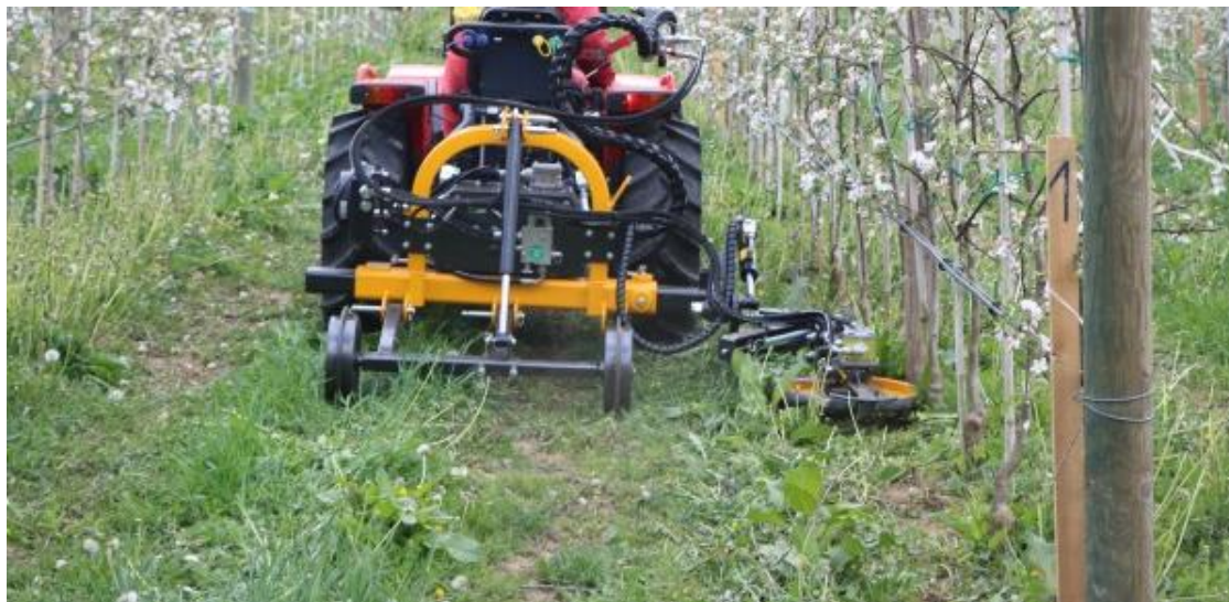
Slika 26: Orizzonti-vrstna krožna kosilnica.
