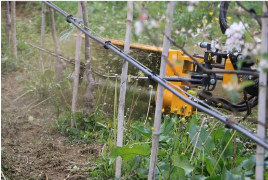
Slika 29: Orizzonti-vrstna kosilnica z nitkami-tipalo.
