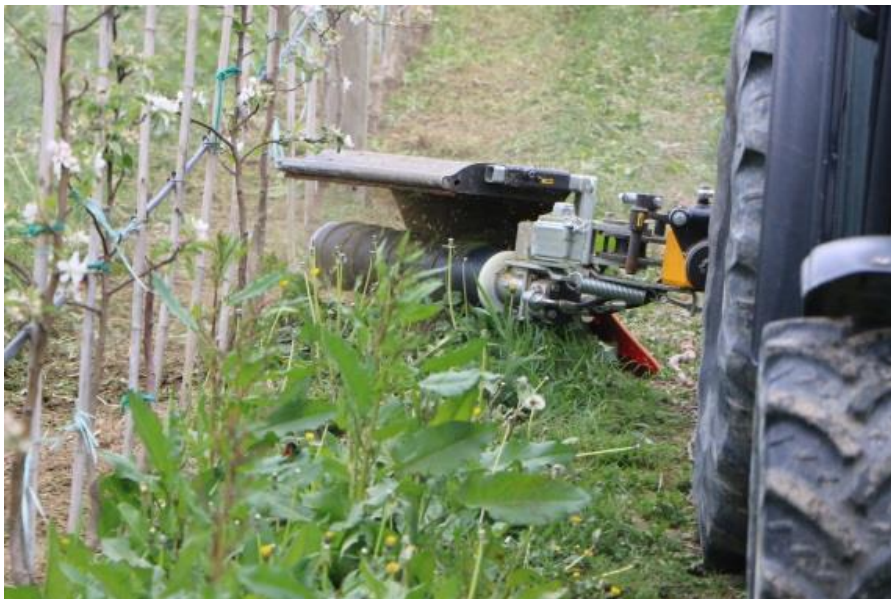
Slika 30: Orizzonti-vrstna kosilnica z nitkami-dolge nitke.
