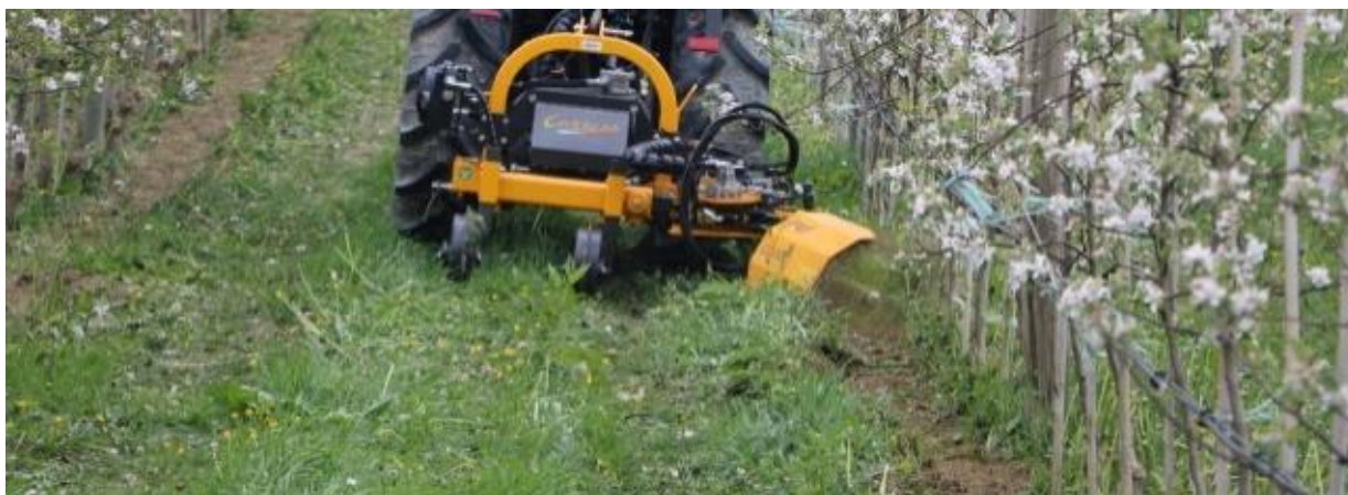
Slika 96: Orizzonti-vrstna kosilnica z nitkami.
