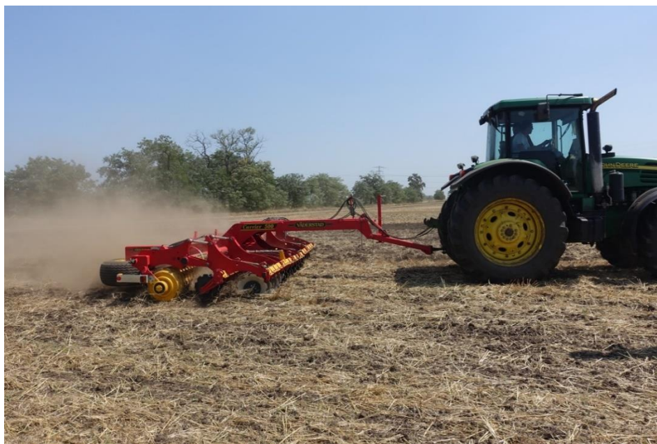
Slika 8: Uporaba krožne brane pri ohranitvenem sistemu obdelave tal
