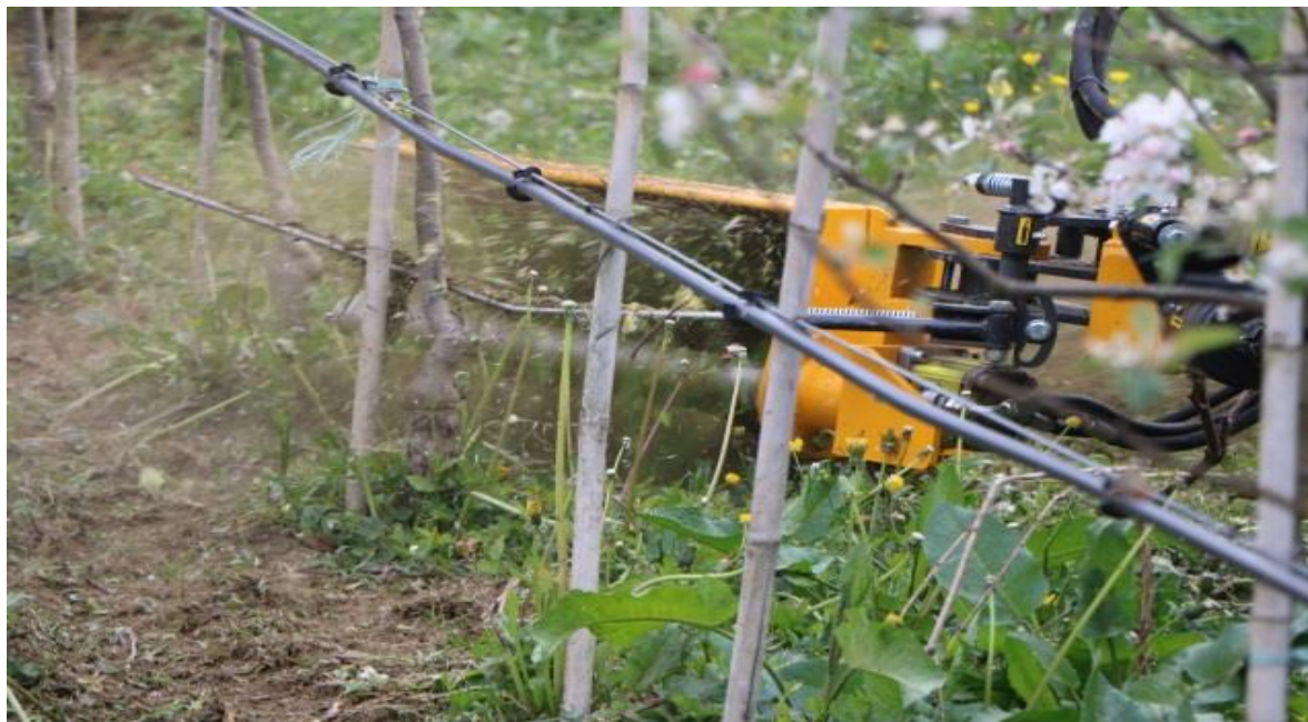
Slika 97: Orizzonti - vrstna kosilnica z nitkami-tipalo.
