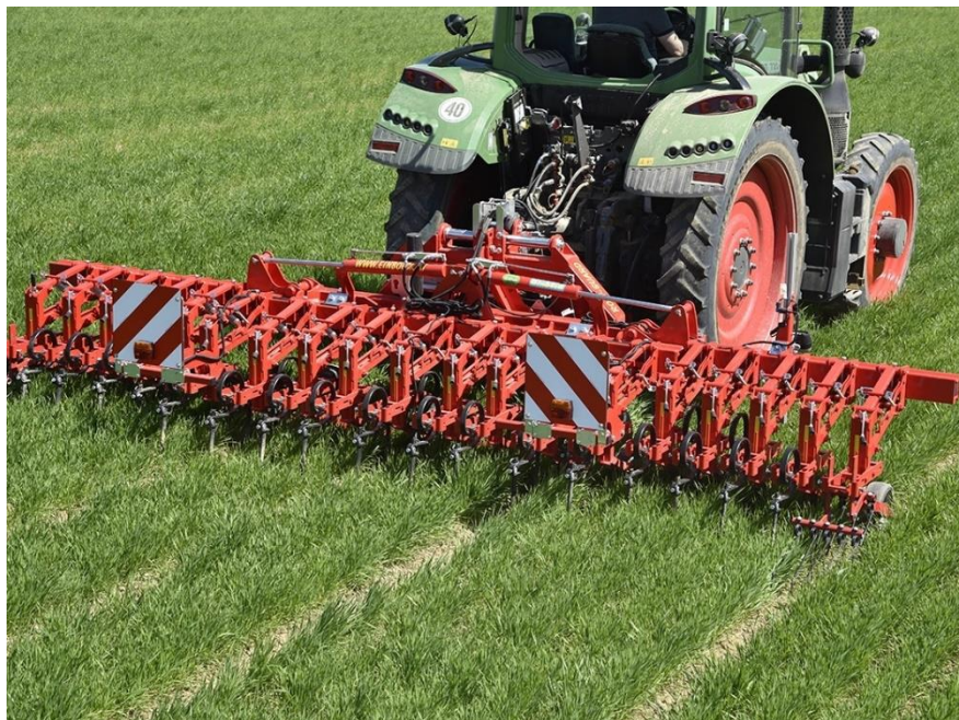
Slika 16: Okopalnik za obdelavo medvrstnega prostora v žitih (Einbock)
