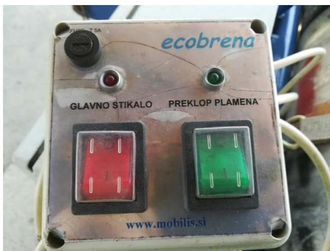
Slika 66: Omarica z ventilom za regulacijo pretoka plina (levo; 4 - Ventil za regulacijo pretoka plina, 8 - Napajalni kabel), upravljalnik za vklop plamena (desno)
