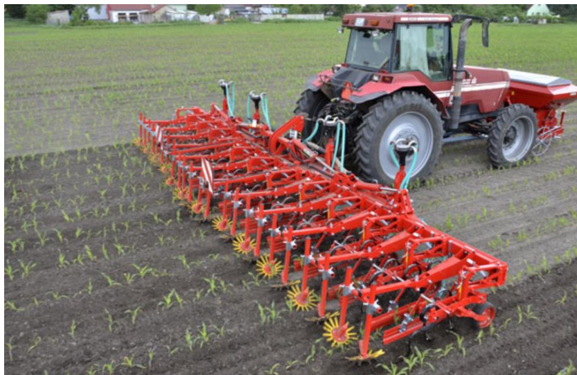
Slika 19: Kombinacija okopalnika in prstastega plevelnika za okopavanje koruze (Einbock)
