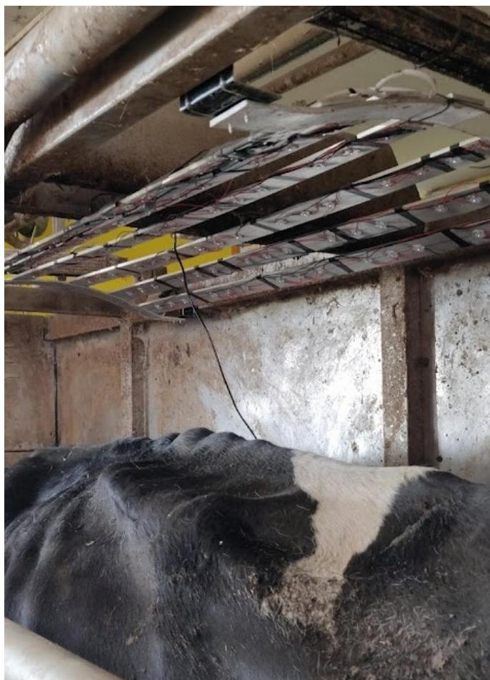
Slika 8: Obsevanje krave z UV LED lučjo, nameščeno v molznega robota Fullwood Merlin 225
