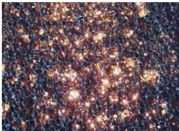
Slika 12: Luknjičava struktura penjenega aluminija [Sauer, 2010: 39]. Figure 12: Porous structure of foam aluminium [Sauer, 2010: 39].
