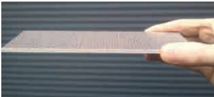
Slika 4: Keramični kompozit: Keramične plošče, ki so lahko velike 150 x360 cm ob minimalni debelini 3 mm [Foto: Koprivec].
