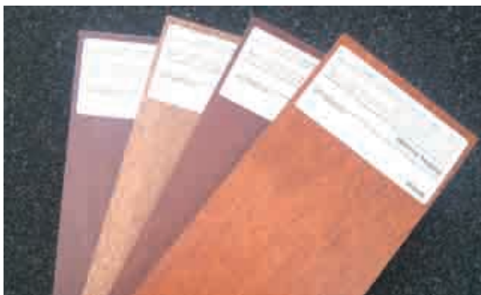
Slika 14: Špansko podjetje Parklex izdeluje kompozitne plošče z bakelitno sredico in naravnim lesnim furnirjem. Plošče so tanke, trdne, večjih dimenzij. Raznolikost zunanje fasadne obloge omogoča obširna paleta lesnih furnirjev [Foto: Koprivec].
