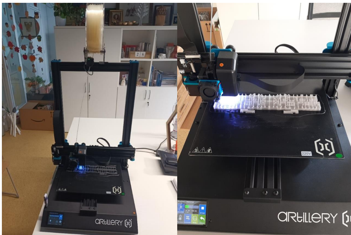
Slika 6. Početak 3D ispisa na 3D pisaču ArtillerySidewinder X1 i pisač u radu
