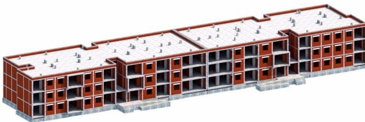
Slika 1. Informacijski model konstrukcije višestambene zgrade
