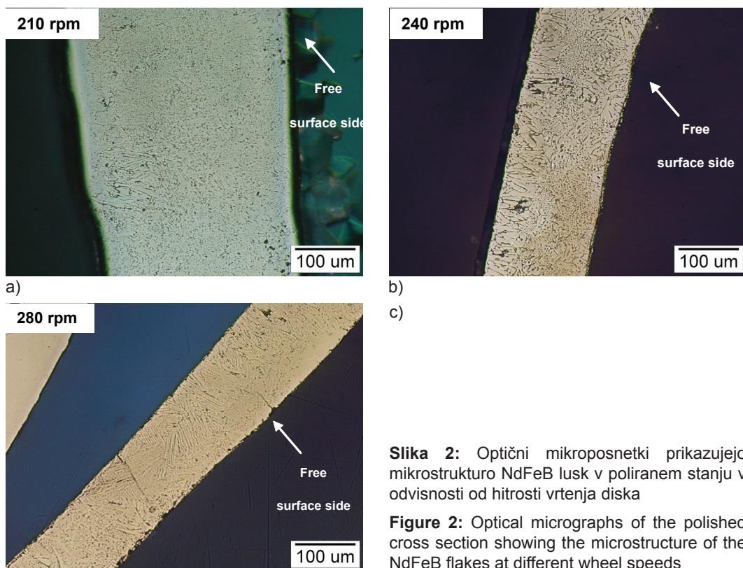
**Slika 2:** Optični mikroposnetki prikazujejo mikrostrukturo NdFeB lusk v poliranem stanju v odvisnosti od hitrosti vrtenja diska
