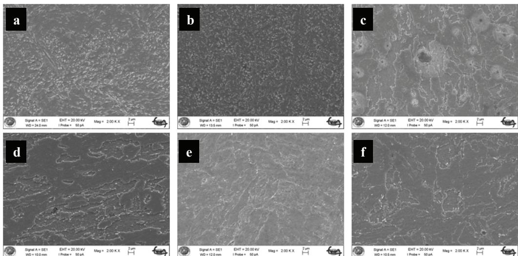
**Slika 2:** SEM-mikroposnetki jekel a) lita mikrostruktura, b) homogenizirano 6 ur pri 1200 °C, nato popuščano 4 ure pri 660 °C, c) homogenizirano 6 ur pri 1200 °C, nato popuščano 4 ure pri 710 °C, d) homogenizirano 6 ur pri 1200 °C, nato normalizirano 1 uro pri 1100 °C, e) homogenizirano 6 ur pri 1200 °C, nato normalizirano 1 uro pri 1100 °C in popuščano 4 ure pri 660 °C, f) homogenizirano 6 ur pri 1200 °C, nato normalizirano 1 uro pri 1100 °C in popuščano 4 ure pri 710 °C
