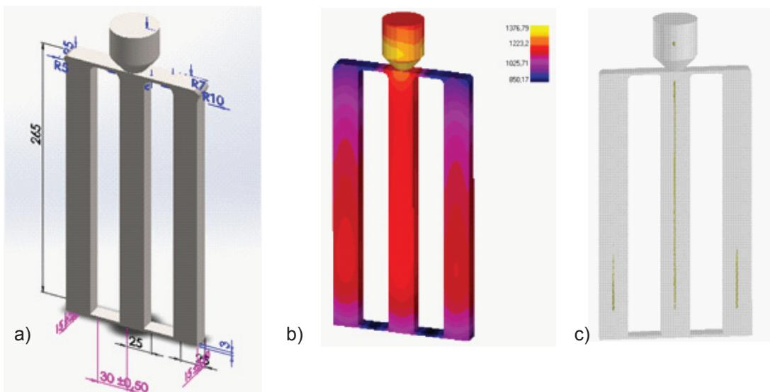
**Slika 1:** a) 3D posnetek vzorca iz jekla 3Cr3W, b) analiza porazdelitve temperature med litjem, c) mikroporoznost ulitih delov, narejena po kriteriju FCC (FranCi Chiesa)
