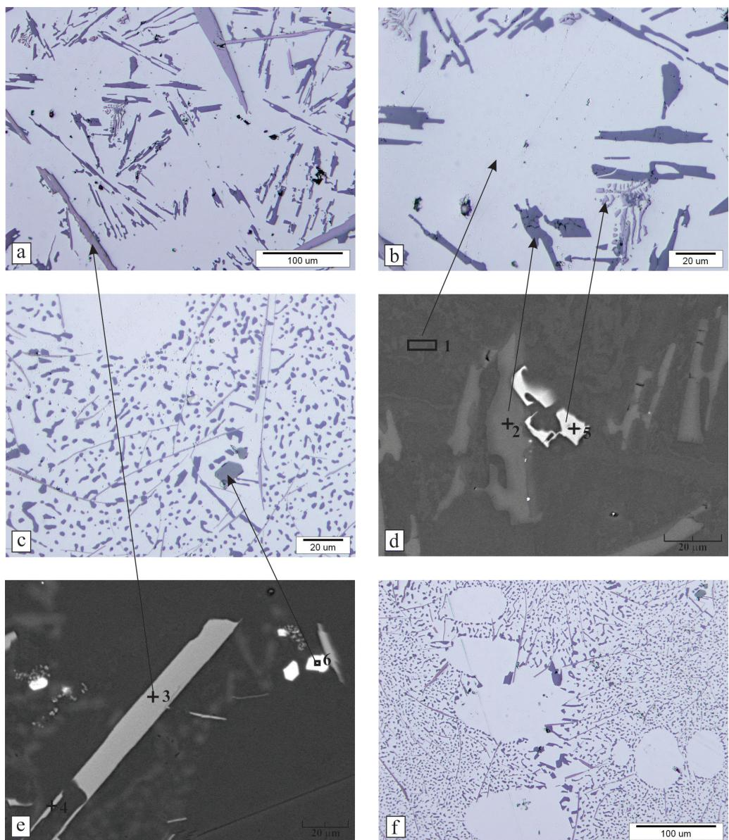
**Slika 3:** Mikrostruktura zlitine AISi12: svetlobnomikroskopski posnetek vzorca 12 z označenimi fazami(a, b), svetlobnomikroskopski posnetek vzorca 12S (c), SEM posnetek vzorca 12 z označenimi mesti EDS analiz (d, e) in svetlobnomikroskopski posnetek vzorca 12S (f); 1 -  $\alpha_{\text{Al}}$ , 2 -  $\beta_{\text{Si}}$ , 3, 4 -  $\text{Al}_9\text{Fe}_2\text{Si}_2$ , 5 -  $\text{Al}_{14}(\text{Fe}, \text{Mn})_4(\text{Al}, \text{Si})_5$ , 6 -  $\text{Al}_2\text{SrSi}_2$
