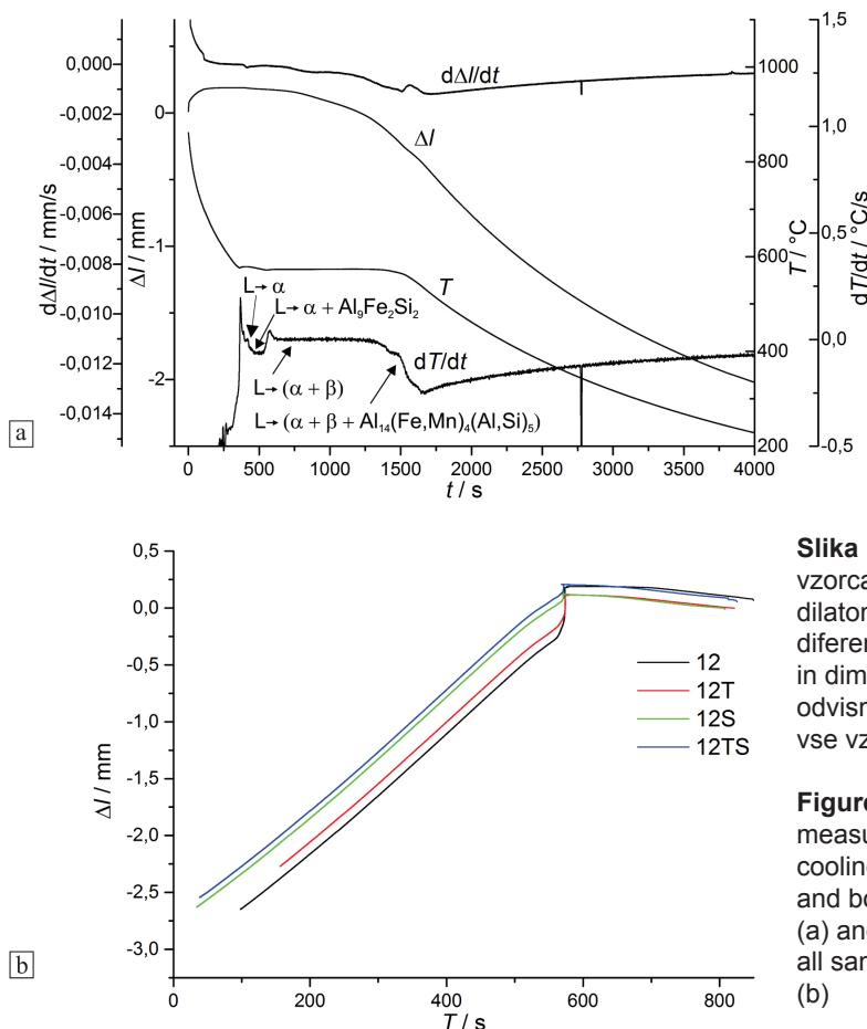
**Slika 1:** Rezultati meritev vzorca 12 z ohlajevalno krivuljo, dilatometrijsko krivuljo in obema diferenciranimi krivuljama (a) in dimenzijske spremembe v odvisnosti od temperature za vse vzorce (b)
