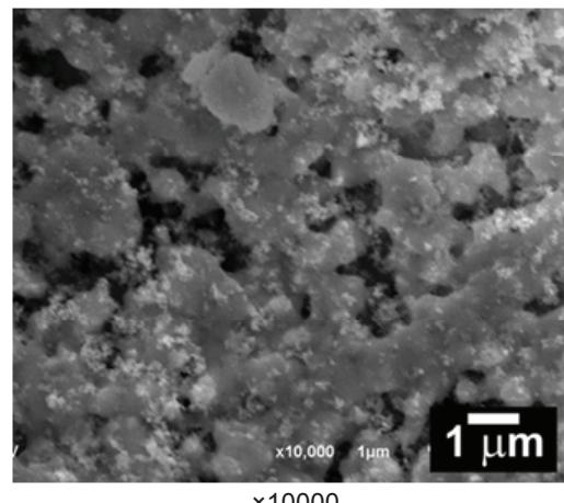
**Slika 1.** Morfologija sestavljenega prahu  $\text{Ag}-\text{SnO}_2$ , izdelana po metodi z uporabo šablone
