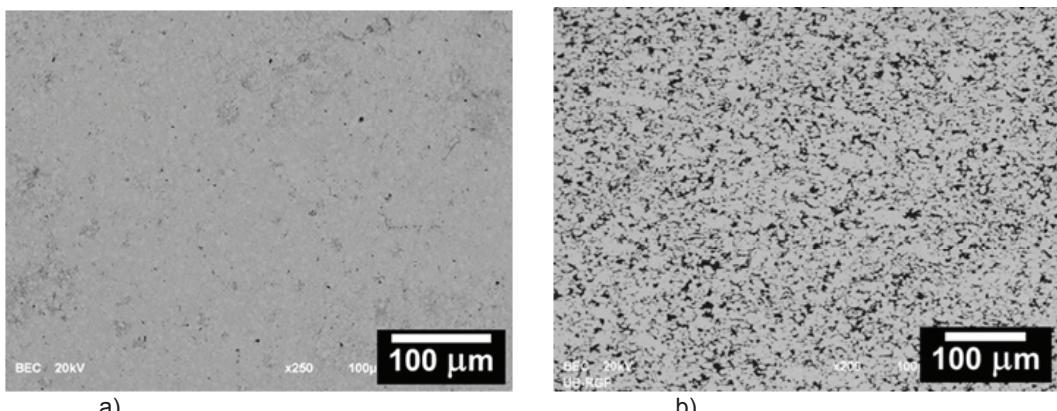
**Slika 4.** Mikrostruktura končnega kontaktnega materiala na osnovi Ag-ZnO, izdelanega po:
