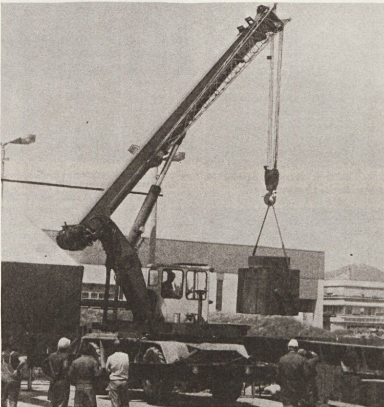
Prototip terenskega dvigala TD-20 med preizkušanjem. Dvigalo je izdelano v kooperaciji s poljsko firmo Bumar.
