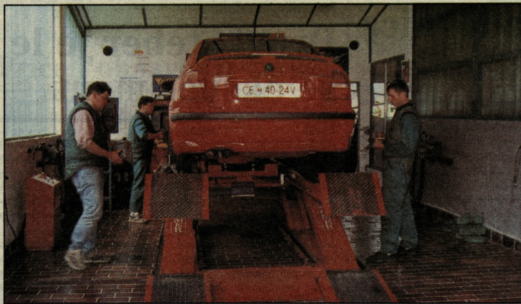
V avtomehaniki AVTO URI med nastavitvijo geometrije koles s sodobnim računalniškim sistemom znamke Corghi.
