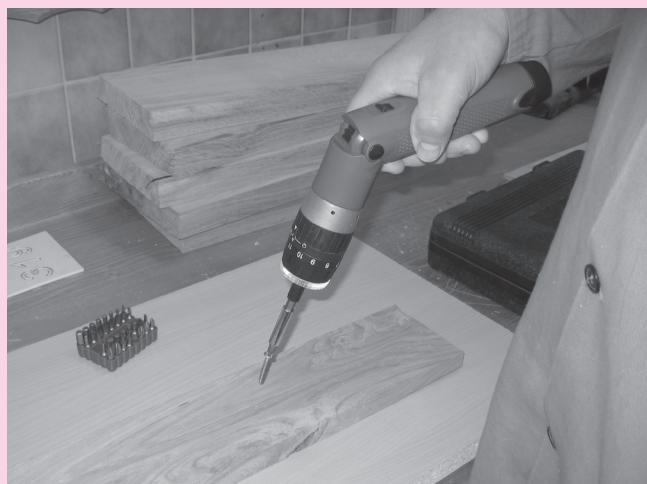
□ Slika 4. Magnetni nastavek zadrži vsak jekleni vijak
