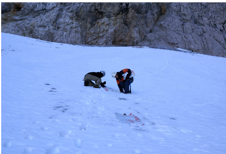
Slika 2 – Namestitev kontrolnih točk na ledenik pod Skuto, 18. 9. 2012. Foto: Blaž Barborič.
