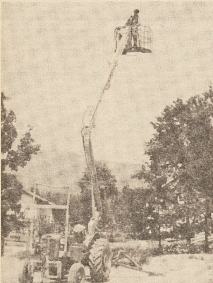
PROIZVODNJA ZA IZVOZ — Rikov obiralec datljev, traktorski priključek, imenovan RP 10, programiran in narejen za Bližnji vzhod. V Riku so si ga z velikim zanimanjem ogledali tudi Kitajci med nedavnim obiskom. Bo šel RP 10 tudi na tako dolgo pot?
