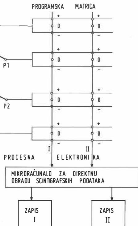
**MICROCOMPUTER IN A RECTILINEAR SCANNER**
