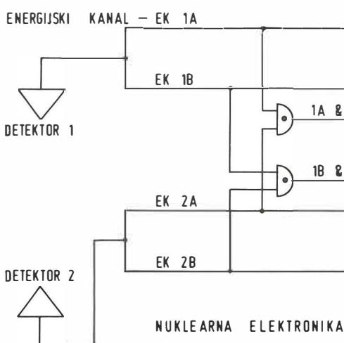
Slika 1 — Funkcionalna shema scintigrafskog sistema. Istaknuta je mogućnost kombinacije aritmetičnih operacija na podacima iz nuklearne elektronike za generisanje scintigrafskih slika u slučaju da je u skener ugrađeno mikroračunalo.
