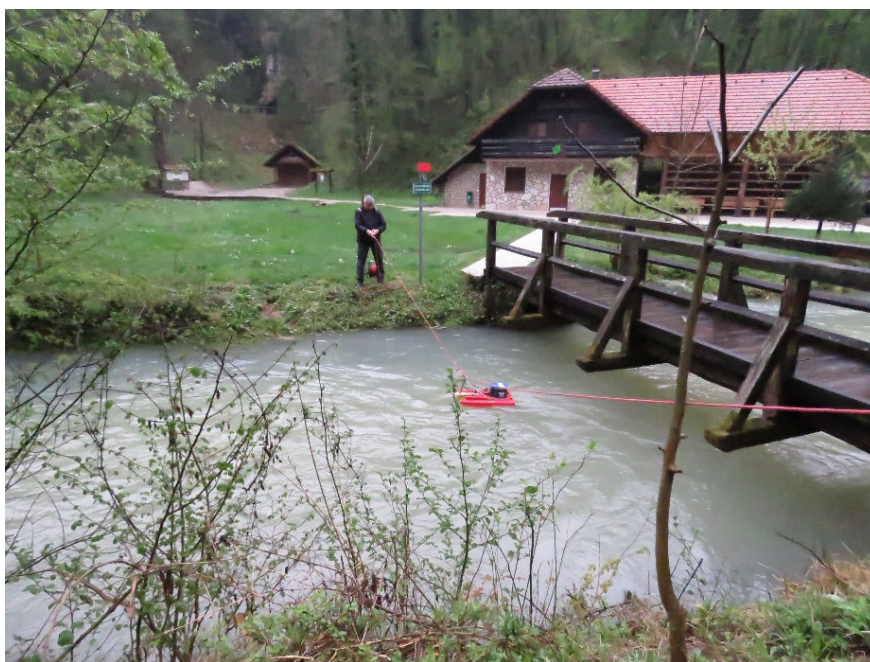
Slika 2. Izvajanje meritev pretoka na območju izvira Studene v Globočicah v času nadpovprečne izdatnosti aprila 2019 (Arhiv ARSO)
