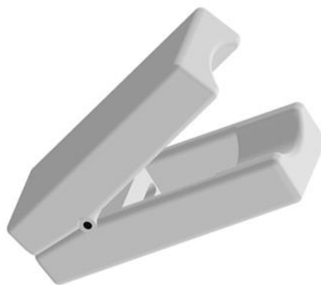
Slika 3. 3D model ohišja pulznega oksimetra. Zasnovano je kot ščipalka, ki zaobjame prst. V notranjosti ohišja so odprtine za namestitev vezja.
