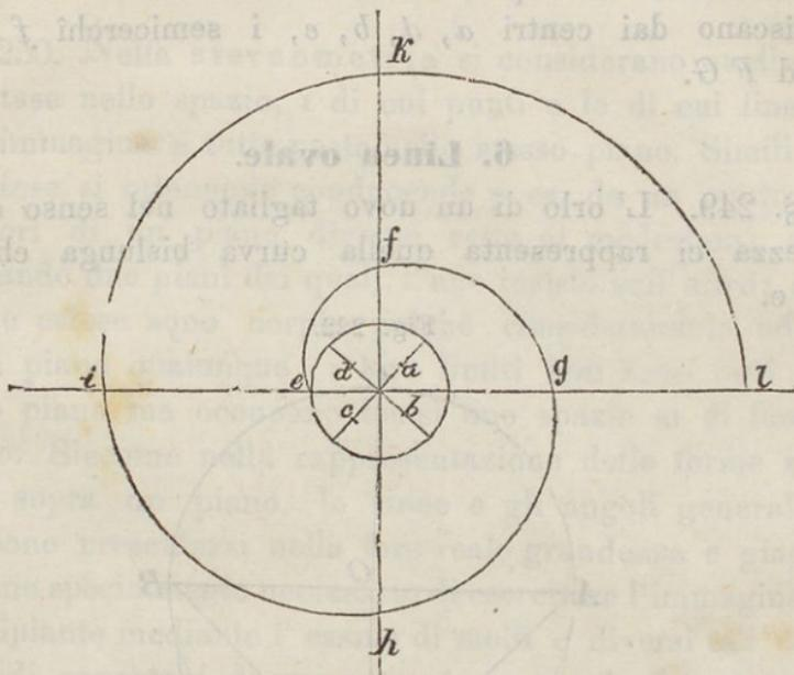
Descrivendo da  $a$  col raggio  $ae$  l'arco  $ef$ , indi da  $b$  l'arco  $gf$ , da  $c$  e  $d$  gli archi  $gh$  e  $hi$  e così via, si ottiene la linea spirale richiesta.
