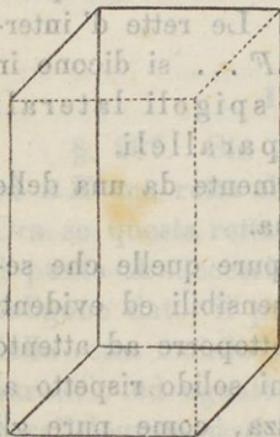
§. 270. Un prisma dove le basi sono parallelogrammi chiamasi parallelepipedo (fig. 241). Questo può essere come tutti gli altri prismi, retto oppure obliquo. Un parallelepipedo è limitato da sei parallelogrammi.
