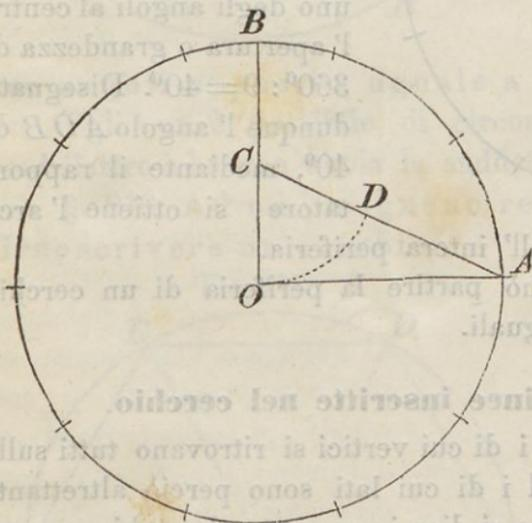
Si conducano (fig.188) due raggi  $OA$  ed  $OB$  perpendicolari a vicenda; indi si divida in  $C$  la  $OB$  per metà e condotta la  $CA$  si prenda la porzione  $CD = OC$ . Presa ora la retta  $AD$  col compasso, essa si può trasportare esattamente 10 volte come corda intorno alla periferia, per cui questa riesce divisa in 10 parti uguali.
