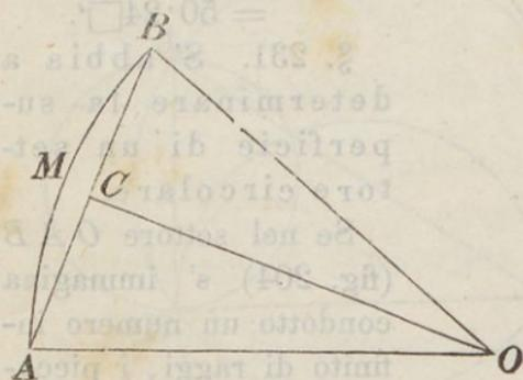
Se dagli estremi di una corda  $AB$  (fig. 205) corrispondente al segmento  $ABM$  si conducono i raggi, si ottiene il settore  $AOB$  il quale si compone del segmento dato e del triangolo  $AOB$ . Calcolando quindi la superficie del settore e sottraendo poscia da quella l'area del triangolo si otterrà l'area del segmento.
