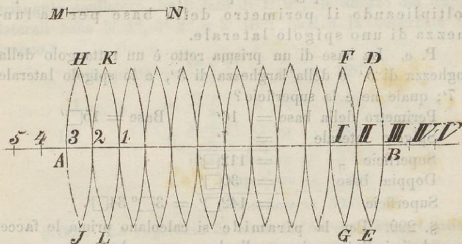
uguale a 10 delle parti suddette, si descrivono gli archi *DE*, *FG*, . . . e collo stesso raggio dai centri *I*, *II*, *III*, . . . gli archi *HJ*, *KL*, . . . questi interchiuderanno 12 figure lenticolari che convenientemente inflesse e ravvicinate danno con sufficiente esattezza la superficie sferica.
