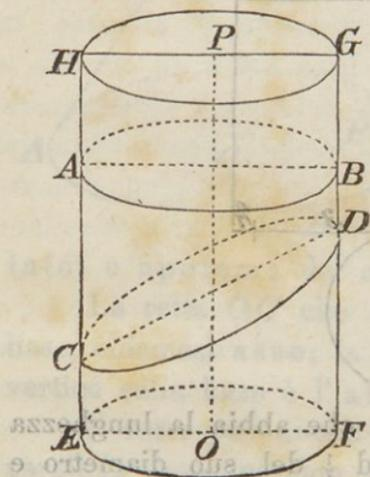
dentemente risulta già dalla generazione del cilindro (§. 284). Se poi il piano secante non è parallelo alla base, e quindi neppure perpendicolare all' asse, la figura  $CD$  della sezione è un' ellisse.
