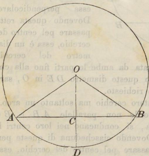
§. 188. Sia  $C$  (fig. 165) il centro della corda  $AB$ , dunque  $AC = BC$ . Conducendo ora  $OA, OB$  ed  $OC$ , che incontra l'arco  $AB$  in  $D$ , il triangolo  $AOC$  è  $\cong BOC$ , quindi l'angolo  $ACO = BCO$  ( $OC \perp AB$ ) ed  $AOC = BOC$ . Ne segue adunque che la retta che unisce il centro di un cerchio col centro di una sua corda è perpendicolare a quest'ultima e divide per metà l'angolo al
