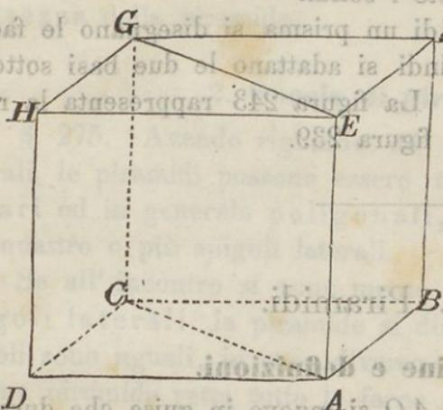
Se si fa passare un piano per due spigoli opposti  $AE$  e  $CG$  (fig. 242) di un prisma, la sezione  $AEGC$  è un parallelogrammo (perché?), e si chiama sezione diagonale del prisma proposto.
