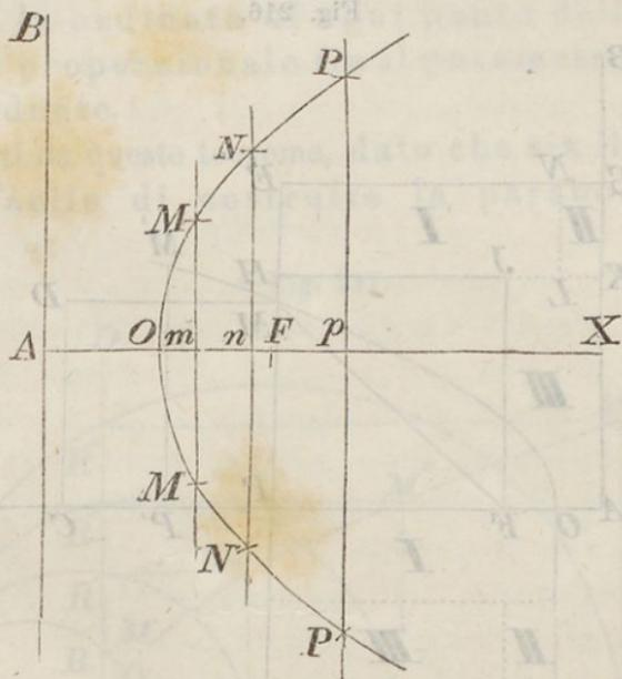
fuoco e dalla direttrice. Similmente determina il punto  $n$  due punti  $N$ , il punto  $p$  due altri punti  $P$ , che appartengono tutti alla stessa parabola. In questa guisa si possono ottenere tanti punti quanti sono necessari a disegnare la parabola colla dovuta esattezza.
