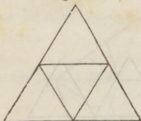
§. 283. 1) Onde ottenere la rete di un tetraedro si disegni (fig. 252) un triangolo equilatero il cui lato abbia la doppia lunghezza dello spigolo del tetraedro; diviso poi ogni lato del triangolo per metà si uniscano i centri mediante rette.
