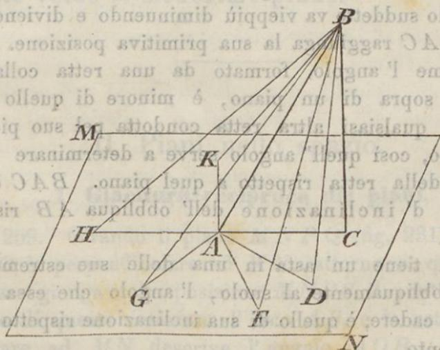
§. 257. Sia  $AB$  (fig. 229) una retta obliqua rispetto al piano  $MN$ . Se dalla sua estremità  $B$  si abbassa la perpendicolare  $AC$  al piano e si congiungono i piedi  $A$  e  $C$  mediante la retta  $AC$ , questa è la proiezione dell'obliqua  $AB$  sopra
