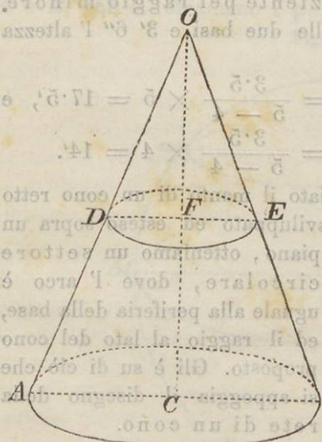
l'altro un corpo contenuto fra i due cerchi paralleli, che chiamasi cono abbreviato ovvero tronco di cono. Se simile tronco di cono retto può immaginarsi generato dal movimento del trapezio  $ACDF$ , di cui un lato non parallelo  $CF$  è perpendicolare ai due paralleli, facendolo ruotare attorno a questo lato  $CF$ . L'altro lato  $AD$  non parallelo descrive girando la superficie convessa;  $AC$  e  $DF$  poi, parallele fra loro, generano le due basi del tronco di cono retto.
