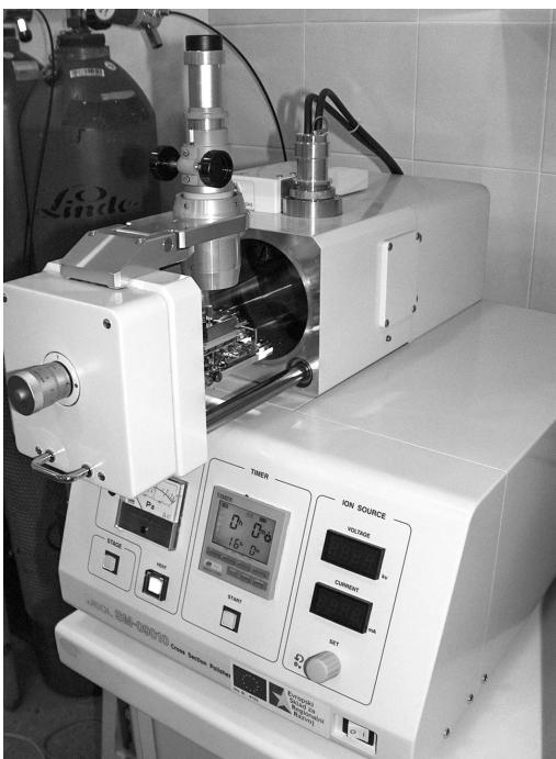
Slika 1: JEOL SM09010 Cross section polisher (naprava za poliranje prereza specifičnih vzorcev, CP)
