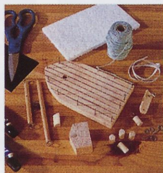
Slika 12. Posamezni postopki izdelave ribiškega čolna s pogonom na gumi. Najprej izžagajte leseno osnovo, na katero prilepite kabino in vse drugo, nato pa na spodnjo stran prilepite še stiropor oziroma
