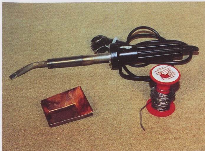
Slika 7. Za spajkanje uporabite čim močnejši spajkalnik (100 W).
