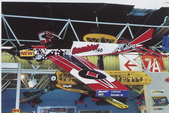
Popolnoma izgotovljen, lesen, s folijo prekrit akrobatski model gambler za motorje 6,5 cm 3 (Ripmax)
