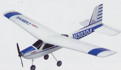
Stiroporni model cessna cardinal z že vgrajenim motorjem tipa 600, razpetino kril 1550 mm in maso 1550 g je idealen je za začetnike (Robbe).
