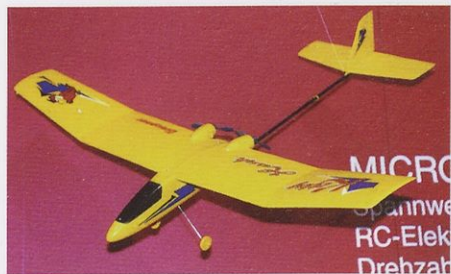
Mali dvomotorni kity hawk z razpetino kril 700 mm in maso 175 g dobite že v kompletu z dvokanalno RV-napravo (Graupner).
