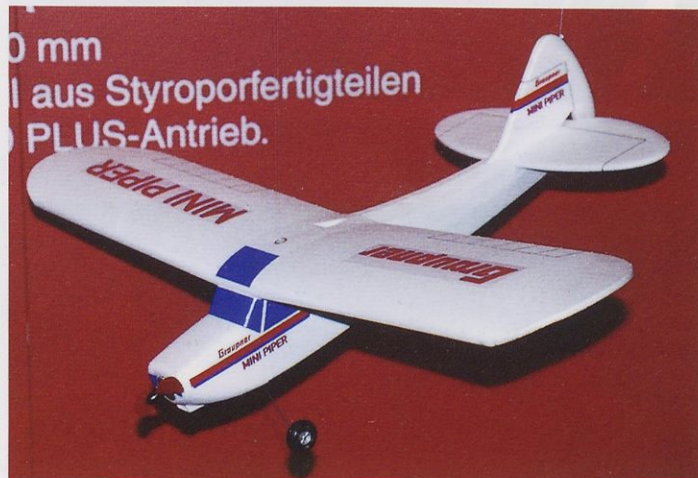
Stiroporni mini piper z razpetino kril 750 mm poganja elektromotor speed 300 (Graupner).
