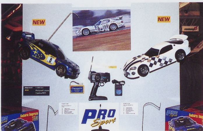
Cenovno ugodna električna modela subaru impreza 2WD in dodge viper z RV-napravo, akumulatorjem Ni-Cd in polnilnikom sta že nared za vožnjo (Mantua model).
