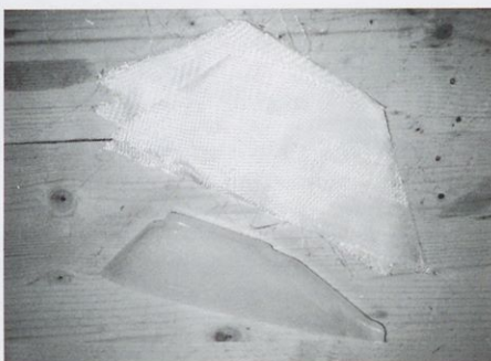
Rezanje tkanine za bombni nosilec. Ta del je enostavne oblike, zato diagonalno polaganje tkanine ni potrebno.
