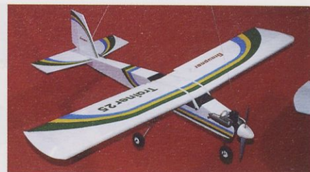
Nekoliko manjši trenažni motorni model trainer 25 z razpetino kril 1380 mm in maso 2000 g je predviden za motor OS 25 LA (Graupner).
