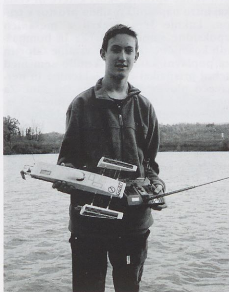
Aleš Založnik z modelom kategorije mini hidro lastne konstrukcije, ki je narejen iz stirodura in prevlečen s tanko stekleno tkanino
