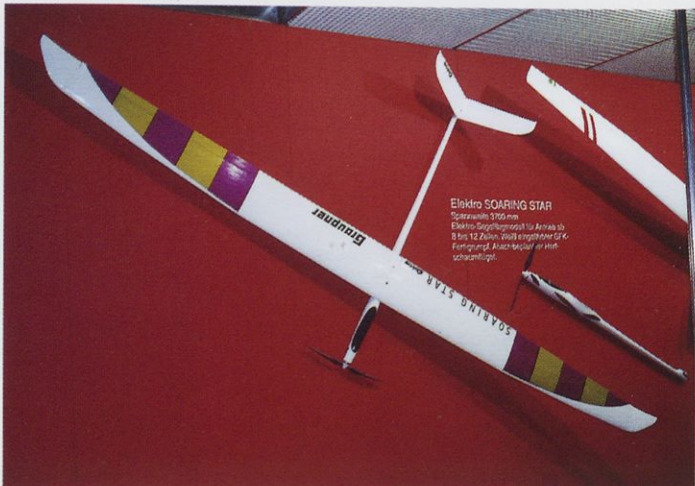
Elektromotorna različica znanega jadralnega RV-modela soaring star. Poganja jo brezkrtačni motor carbon 70 z reduktorjem, ki se napaja z 8–12 celicami 2400 mAh (Graupner).
