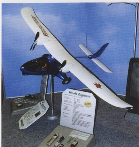
Dvomotorni model movie star iz serije Pico Line je prirejen za fotografiranje iz zraka. Vanj lahko vgradimo klasični ali digitalni fotoapararat (Multiplex).
