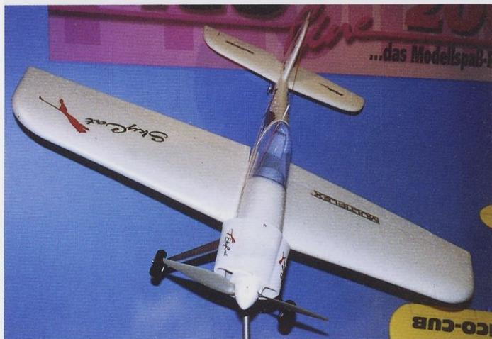
Stiroporni sky cat (1080 mm) z možnostjo električnega pogona ali motorja z notranjim zgorevanjem 3,5 do 4,5 cm 3 . Na sliki je elektromotorna različica z motorjem Permax 600 in prenosom 3 : 1.
