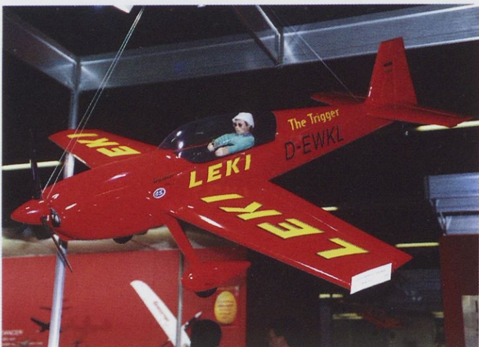
Extra 300 L je model klasične lesene gradnje. Čez krila meri 1800 mm in tehta 5,4 kg. Poganja ga motor OS 108 (Graupner).
