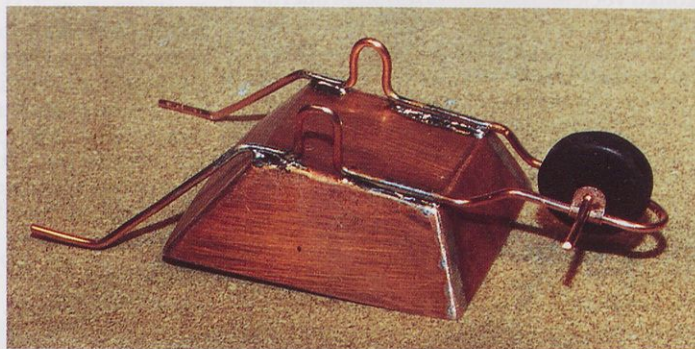
Slika 10. Nameščanje osi kolesa in nosilcev osi na ogrodje
