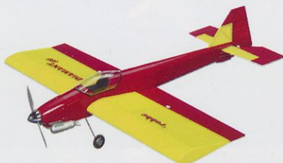
Diamant 40 je fun-fly model za 3D ter akrobatsko letenje. Model je sestavljen ter prekrit. Razpetina kril 1280 mm, masa 2200 g, motor 6,5 cm 3 (Robbe).
