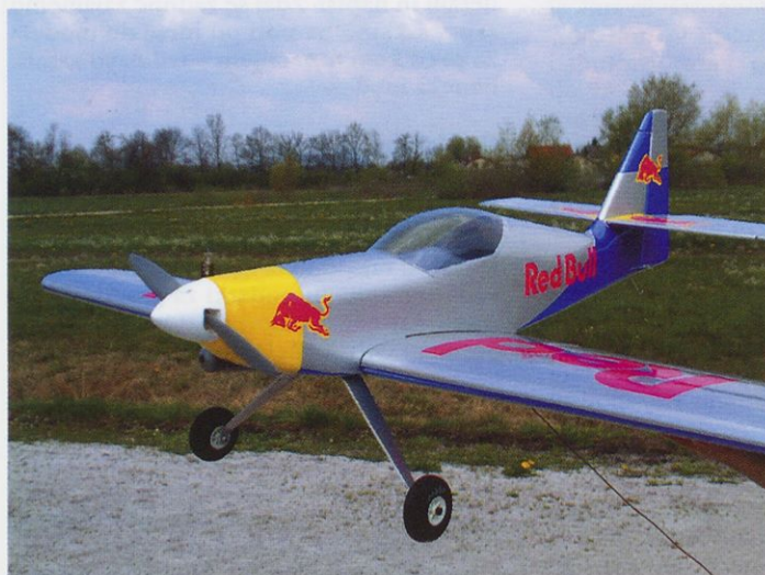
Barvna shema tako na zgornji kot na spodnji strani modela zahteva veliko ročnega dela. Vsi napisi in emblemi so ročno izrezani iz folije za prekrivanje.
