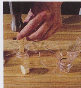
Slika 15. Izdelava pogonske turbine za hitri čoln. Od platenke s premerom 70 mm odrežite zgornji del. Odstranite vrat z navojem, preostali del pa s škarjami oblikujte v vetrnico, kot je prikazano na sliki 9. V odprtino nabijte ustrezno velik kos okrogle palice in ga na sredini prevrtajte.
