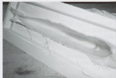
Tkanino 80 g/m 2 nanesemo v dveh plasteh. Stene nosilca morajo le obdržati obliko, nosilnost pa dosežemo s po dvema rebroma na točkah vpenjanja bombe.
