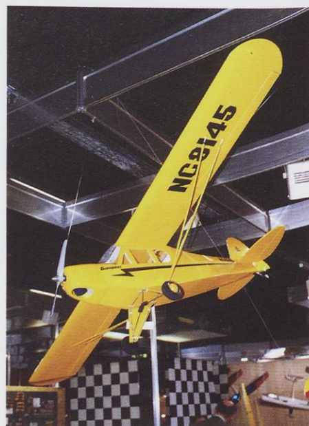
Vedno privlačni piper cub J3. Model lesene konstrukcije z razpetano kril 1840 mm je že prekrit s superfilmom in nared za let z motorjem 7,5 cm 3 (Graupner).
