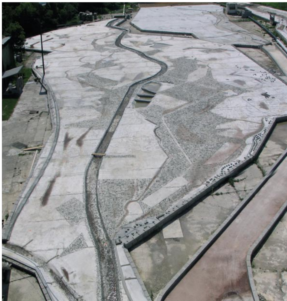
Slika 9 • Prikaz izdelanega fizičnega modela od mesta Krško do sotočja Save s Krko (Inštitut za hidravlične raziskave)
