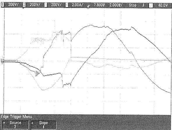
Slika 6b: Izklop trifaznega toka z začetkom pri faznem kotu 30^\circ
