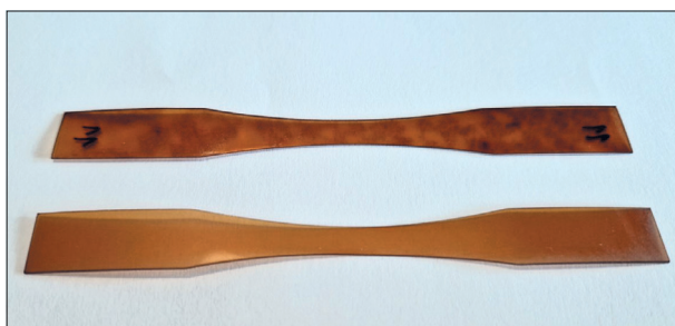
Slika 5. Preizkušanca filma P2C4KT (spodaj) in filma P4KT (zgoraj) – primerjava porazdelitve KT v PVA/CNF sistemu oziroma v PVA matrici.
