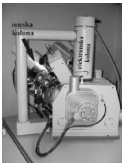
Slika 1: Naprava z dvojnimi elektronskim curkom Quanta 3D, FEI Company, ki je instalirana v Univerzitetnem centru za elektronsko mikroskopijo Fakultete za strojništvo Univerze v Mariboru
