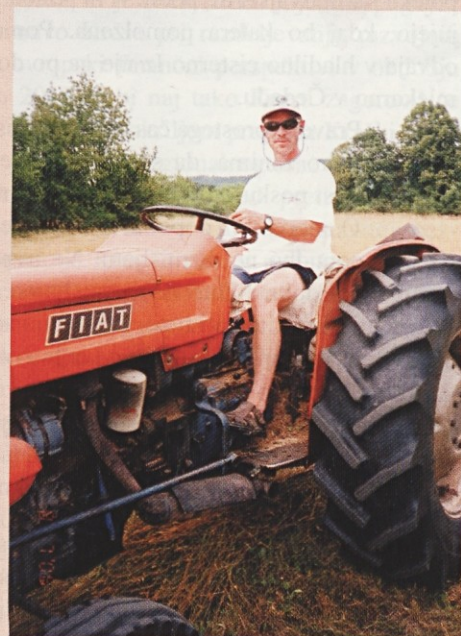
Borut Komel iz Škrbine ima na traktorju prirejeno koso posebej za košnjo na neravnih travnikih.
