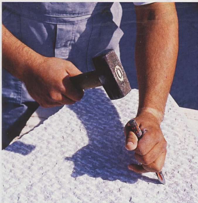
Ročna obdelava kamna - špičenje, česar ne more nadomestiti noben stroj.
