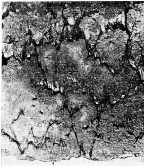
Slika 1 Videz raztrgane površine valjanca
