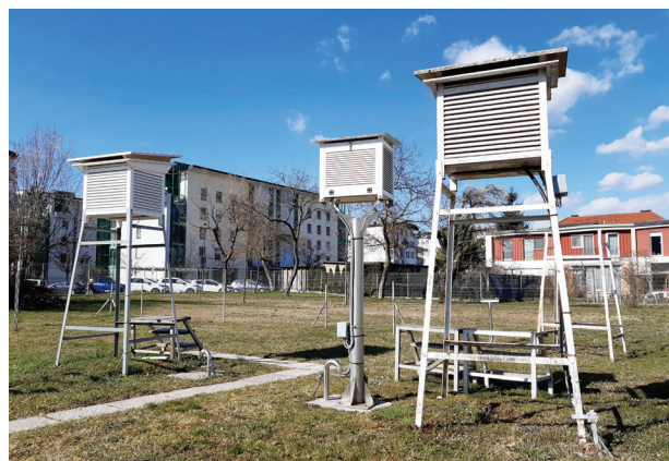
Slika 1. Termometerska hišica za ročne meritve oziroma meritve starejših samodejnih postaj (leva in desna hišica) in novejši tip hišice, v kateri se izvajajo samodejne meritve merilne mreže BOBER (v sredini) na meteorološki postaji Ljubljana Bežigrad
