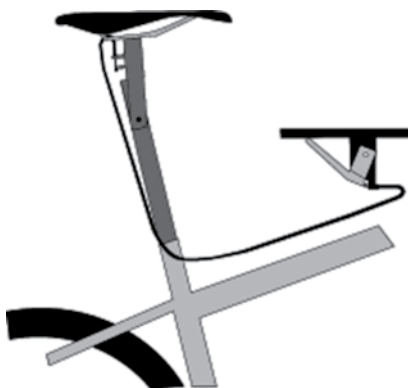
Slika 1: Nastavljiva sedežna opora omogoča spreminjanje vzdolžne lege in naklona sedeža. Položaj sedeža je mogoče postaviti v tri različne pozicije: (i) normalna oz. vodoravna postavitev sedeža, (ii) 10 % naklona sedeža in (iii) 20 % naklona sedeža. Nastavitev položaja sedeža je omogočena z oddaljenim nadzorom preko ročice na krmilu.
