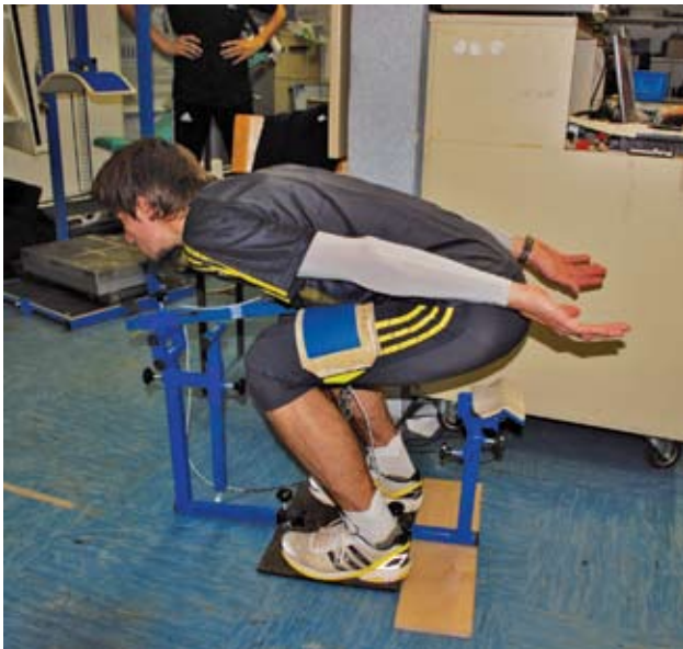
Slika 4: Vadbena naprava za diagnostiko in razvoj izometrične komponente iztegovalk nog v kolenskem in skočnem sklepu v fazi počepa smučarjev skakalcev
