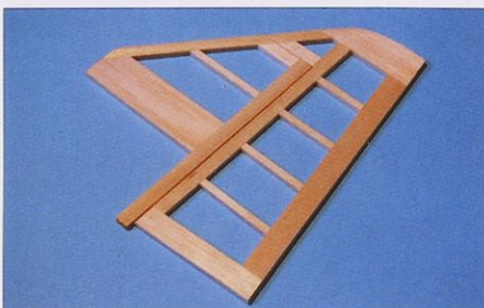
Za trdno in lahko konstrukcijo je zelo pomembno, da se vsi deli pred lepljenjem tesno prilegajo med seboj.
