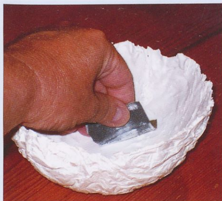
Slika 8. Brušenje notranje površine keramične skodelice
