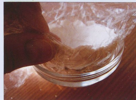
Slika 6. Dviganje izdelka s folijo iz kalupa
