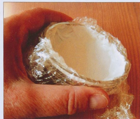
Slika 5. Oblivanje keramične mase po stenah kalupa
