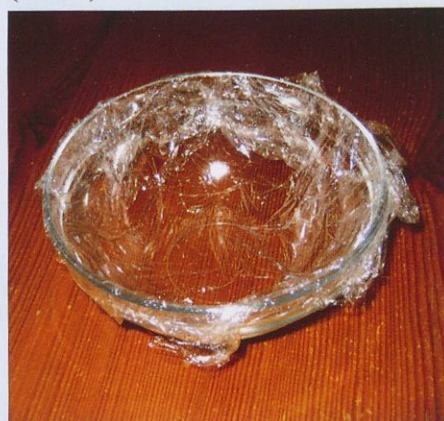
Slika 4. Priprava kalupa za oblivanje sten s keramično maso
