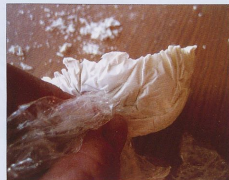
Slika 7. Odstranjevanje prozorne folije s površine izdelka
