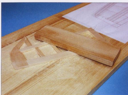
Pri brušenju si pomagamo z brusilno deščico, brusimo na ravni podlagi. Pazimo na enakomeren pritisk, da z brušenjem ne naredimo dodatnih neravnin.
