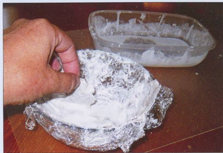
Slika 17. Polaganje prepojenega papirja na steno kalupa
