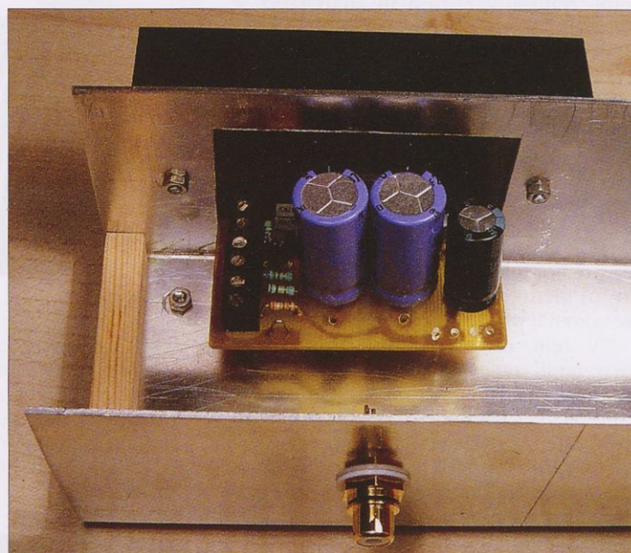
Čip U1 in s tem celotno tiskano vezje pritrđimo na hladilnik z dvema vijakoma. Na enak način pritrđimo hladilno površino na ohišje ojačevalnika.
