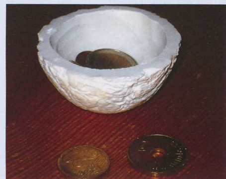
Slika 15. Keramična skodelica, izdelana z vlivanjem in dolbenjem keramične mase
