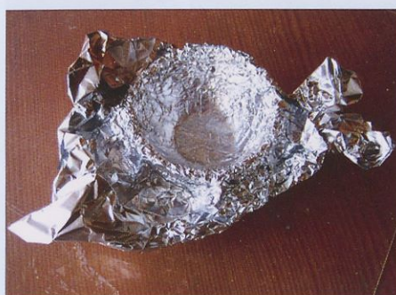
Slika 11. Oblaganje kalupa z zmečkano alu-folijo
