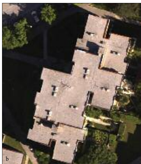
Slika 2: Shematični prikaz izdelave ortofota: (a) ob uporabi digitalnega modela reliefa (DMR) dobimo navadni (na primer državni ortofoto), (b) ob uporabi digitalnega model površja (DMP) pa pravi ortofoto.
