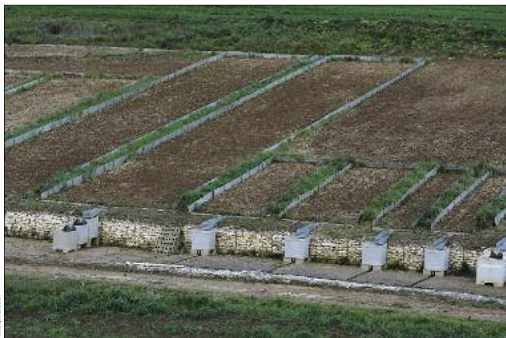
Slika 3: Erozijska polja Univerze v Palermu na posestvu Sparacia.
