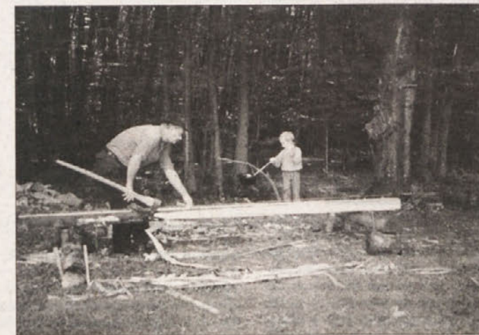
Tesaenje smrekovega debela v tram zahteva od tesarja zelo natančno delo s tesačo. Čeprav sem star že 72 let, še vedno rad primem za tesačo, da mladim pokažem, kako sem si v mladosti služil kruh.
