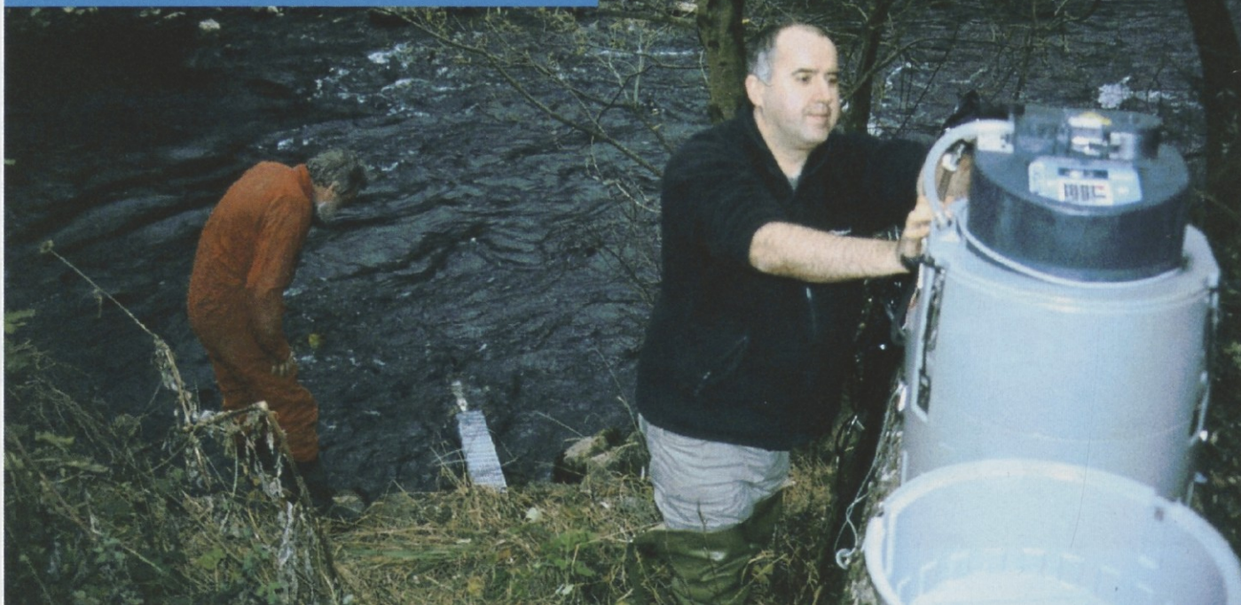
Slika 1: Postavitev sond za meritve temperature, specifične električne prevodnosti, vsebnosti raztopljenega kisika in pH ter avtomatskega zajemalnika pri vodarni Kraškega vodovoda pri Dolenjih Vremah.
