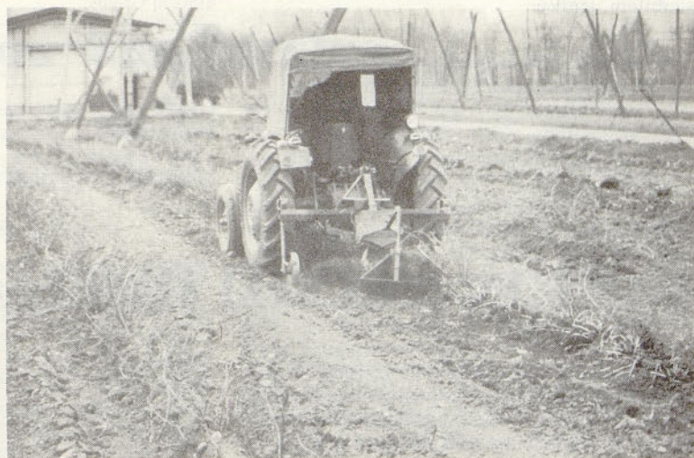
Izboljšava rezalnika s podpornimi kolesi za stalno in enakomerno ravnino rezi
