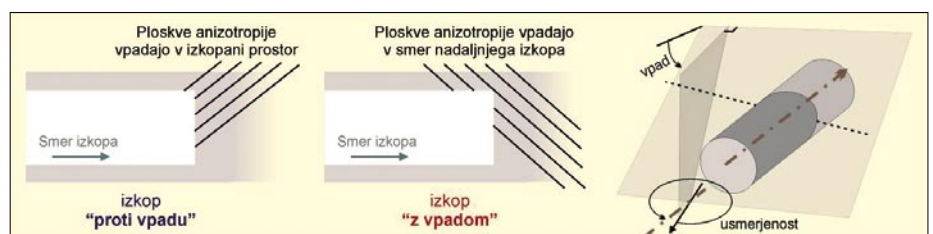
Slika 3 • Razlaga izrazov izkopa z vpadom in izkopa proti vpadu
