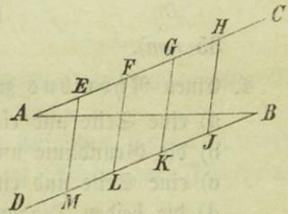
§. 77. 1. Ein Parallelogramm zu construieren, wenn zwei Seiten und der von ihnen eingeschlossene Winkel gegeben sind.
