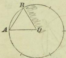
§. 99. Es sei (Fig. 83)  $O$  der Mittelpunkt eines Kreises und  $AB = AO$ . Das Dreieck  $ABO$  ist gleichseitig, daher jeder Winkel desselben gleich  $60^\circ$ .
