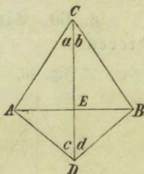
Weil nun  $AC = BC$ ,  $CE = CE$  und  $a = b$  ist, so ist  $\triangle ACE \cong BCE$ , daher  $AE = BE$ . Die Grundlinie AB wird also durch die Gerade CD im Punkte E halbiert.
