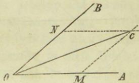
4. Einen Winkel AOB (Fig. 14) in zwei gleiche Theile zu theilen, oder zu halbieren. — Man mache  $OM = ON$  und bestimme einen Punkt C so, daß er von M und N gleich weit entfernt ist; zieht man dann OC, so ist Winkel  $AOC = BOC = \frac{1}{2}AOB$ .
