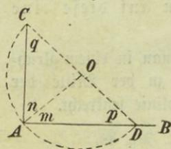
2. Auflöf. Man nehme (Fig. 50) über der Geraden AB einen Punkt O an, beschreibe aus demselben mit dem Halbmesser OA einen Kreisbogen CAD und ziehe durch D und O eine Gerade, welche jenen Bogen in C durchschneidet; verbindet man diesen Punkt C mit dem gegebenen Punkte A durch eine Gerade AC, so ist diese die verlangte Senkrechte.
