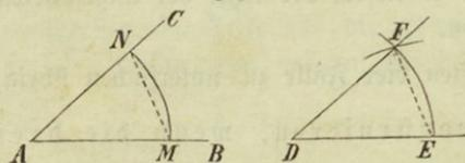
6. Einen Winkel BAC (Fig. 34) zu übertragen, d. i. einen Winkel zu zeichnen, welcher dem Winkel BAC gleich ist.
