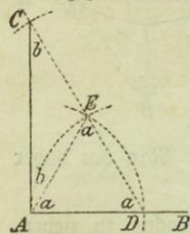
Die Richtigkeit dieses Verfahrens ist leicht einzusehen. Vermöge der Construction ist das Dreieck ADE gleichseitig und das Dreieck ACE gleichschenkelig. Im  $\triangle ADE$  ist daher jeder der drei Winkel  $a = 60^\circ$ ; im  $\triangle ACE$  ist jeder der zwei gleichen Winkel  $b$  an der Grundlinie die Hälfte des Außenwinkels  $a$ , also  $b = 30^\circ$ . W mithin ist Winkel  $BAC = a + b = 60^\circ + 30^\circ = 90^\circ$ , und daher  $AC \perp AB$ .
