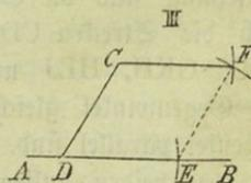
3. Lösung. Ziehe (Fig. 62, III) durch C eine Gerade, welche die AB in D scheidet, und beschreibe aus D mit dem Halbmesser CD einen Kreisbogen, welcher die AB in E schneidet; beschreibt man dann mit demselben
