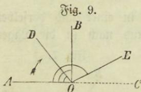
Der Winkel  $AOD$ , welcher kleiner als ein rechter ist, heißt ein spitzer Winkel. Der Winkel  $AOE$ , welcher größer als ein rechter Winkel ist, heißt ein stumpfer Winkel. Ein spitzer und ein stumpfer Winkel werden auch schiefe Winkel genannt.
