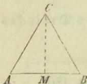
Zeichne (Fig. 31) eine Strecke AB, errichte in der Mitte M derselben eine Senkrechte und bestimme in ihr den dritten Dreieckspunkt C so, daß er von A und von B so weit entfernt ist, wie A von B.
