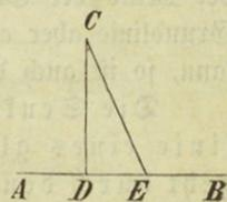
Die Senkrechte von einem Punkte auf eine Gerade dient dazu, um die Entfernung jenes Punktes von der Geraden zu messen.
