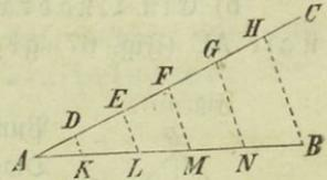
b) Um die vielen Parallelen zu vermeiden, lege man an AB (Fig. 64) durch A die beliebige Gerade AC, und durch B die  $BD \parallel CA$ , trage sowohl auf die AC als BC 4 gleiche Theile auf, und ziehe durch die Theilungspunkte die geraden Linien EM, FL, GK, HJ, so theilen diese die AB in 5 gleiche Theile.
