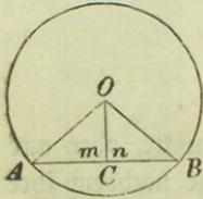
1. Zieht man in einem Kreise vom Mittelpunkte eine Senkrechte auf eine Sehne, so wird diese dadurch halbiert.
