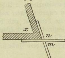
Dieser Satz findet praktische Anwendung, wenn (Fig. 21) ein Innenwinkel  $x$  eines Gebäudes, eines Gartens oder eines eckigen Gefäßes gemessen werden soll und man nicht in das Innere gelangen kann; man darf nur den äußeren Scheitelwinkel  $m$  messen und  $x = m$  setzen.
