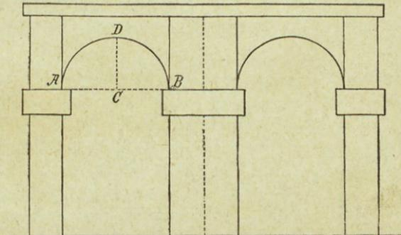
§. 113. 1. Wird über einer gegebenen Strecke AB (Fig. 99) aus ihrem Mittelpunkte C ein Halbkreis beschrieben, so heißt dieser ein Rundbogen oder voller Bogen; die Strecke AB nennt man die Spannweite, die Punkte A und B die Anläufe, die in C auf AB errichtete Senkrechte CD die Pfeilhöhe und D den Schluss des Bogens.
