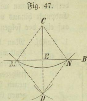
Um aus einem Punkte zu einer Geraden eine Senkrechte zu ziehen, beschreibe man aus jenem Punkte einen Kreisbogen, welcher die Gerade in zwei Punkten schneidet; aus diesen beschreibe man wieder mit demselben Halbmesser zwei Bogen, die sich in einem Punkte schneiden, und verbinde diesen Punkt mit dem gegebenen Punkte durch eine Gerade; diese ist die gesuchte Senkrechte.
