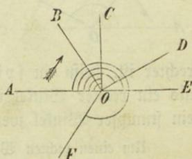
stabe an dem einen Schenkel, dann der Buchstabe am Scheitel, und zuletzt der Buchstabe am andern Schenkel ausgesprochen wird. In dem Winkel (Fig. 8) ist  $O$  der Scheitel,  $OA$  und  $OB$  sind die Schenkel; der Winkel heißt daher: Winkel  $O$ , oder Winkel  $m$ , oder Winkel  $AOB$  oder  $BOA$ .
