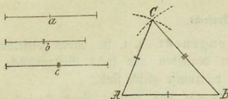
Punkte C schneiden, so ist C der dritte Endpunkt des Dreiecks. Man ziehe daher die Strecken AC und BC; dann ist ABC das verlangte Dreieck. Durch drei Seiten ist also die Größe und Gestalt eines Dreiecks vollkommen bestimmt.
