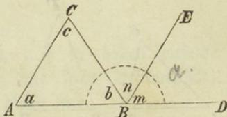
§. 42. Wird in dem Dreiecke ABC (Fig. 29) die Seite AB verlängert und durch B die BE  $\parallel$  AC gezogen, so entstehen die zwei Winkel m und n, von denen m dem Winkel a als Gegenwinkel, n dem Winkel c als Wechselwinkel gleich ist. Die Summe der drei Winkel a, c, b ist daher so groß, als die Summe der Winkel m, n, b. Die letztere Summe aber beträgt einen gestreckten Winkel oder zwei Rechte; also muß auch die Summe von a, c und b zwei Rechte betragen.
