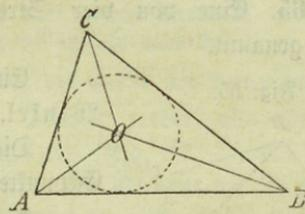
2. Ziehe von jedem Eckpunkte eines Dreieckes eine Gerade, welche den Winkel an jener Ecke halbiert — eine Winkelhalbierungslinie. (Fig. 52.)
