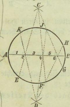
Geometrisch lassen sich nur diejenigen Theilungen der Kreislinie ausführen, bei denen der entsprechende Centrwinkel geometrisch construirt werden kann. Hierher gehören zunächst folgende Aufgaben:
