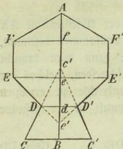
eine feste Verbindung um  $AB$  als Achse um, so heißt das Gebilde  $ABC'D'E'F'$ , welches man dadurch erhält, mit dem gegebenen Gebilde  $ABCDEF$  symmetrisch, und die Gerade  $AB$ , um welche die Umwendung geschieht, die Symmetrieachse oder Symmetrale.
