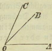
§. 24. 1. Dreht man in dem Winkel AOB (Fig. 12) den Schenkel OB von OA weg, bis er in die Lage OC kommt, so entsteht der Winkel AOC, welcher so groß ist, als die beiden Winkel AOB und BOC zusammengenommen; der Winkel AOC ist also die Summe der Winkel AOB und BOC.
