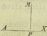
Zieht man in einer Ebene von einem bestimmten Punkte  $A$  (Fig. 72) einen Strahl  $AX$ , und fällt von irgend einem Punkte  $M$  auf diesen Strahl eine Senkrechte  $MP$ , so heißt das dadurch abgeschnittene Stück  $AP$  des Strahles die Abscisse, die Senkrechte  $MP$  selbst aber die Ordinate, und beide zusammen die Coordinaten
