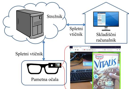
Slika 1: Ilustrativni prikaz zgradbe podpornega sistema navidezne resničnosti. Sistem sestavljajo tri komponente: pametna očala, skladiščni računalnik in strežnik. Uporabnik na pametnih očalih vidi sliko objekta z detekcijskim oknom, ki se glede na rezultat preverjanja istovetnosti obarva zeleno (pravilen objekt) oz. rdeče (nepravilen objekt).
