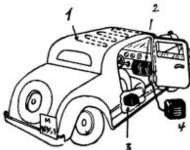
Avto z vdelanim aparatom: 1 antena, vdelana v streho, 2 sprejemnik, nameščen tako, da ga voznik med vožnjo lahko uravnava, 3 akumulator, 4 zvočnik, ki se da postaviti kamorkoli; če se ustavo ustavi kje na prostem za picknick, je takle zvočnik kot nalašč...
