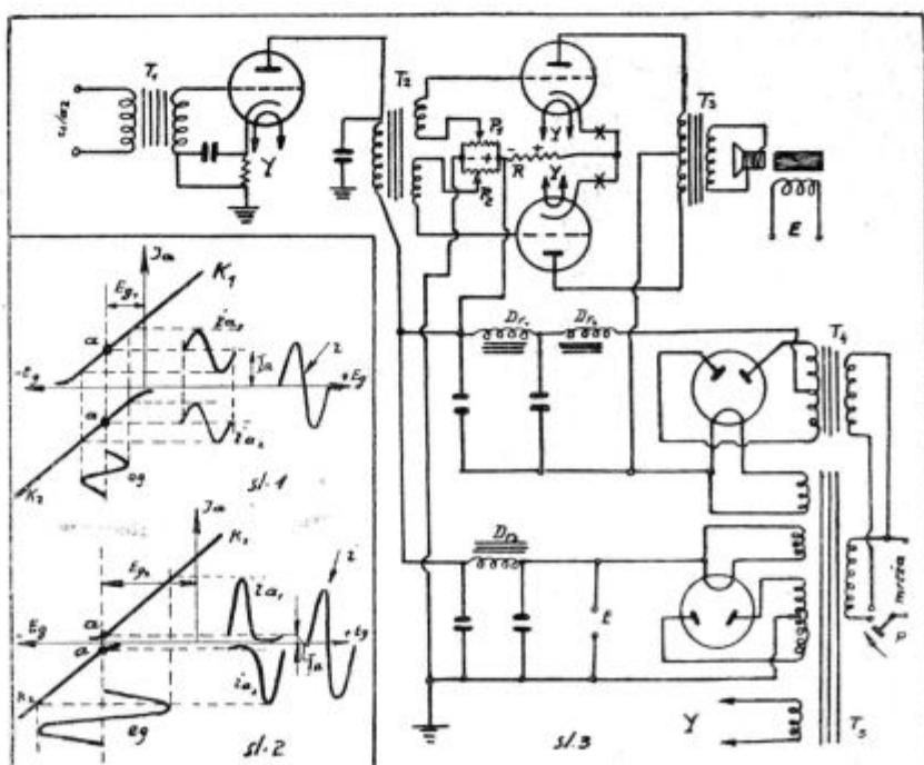
je ne može se kod te klase negativan prednapon Eg dobiti sa krajeva otpora (obično katodnog) koji je uključen u anodno kolo cevi. Potrebna je zasebna baterija ili ispravljačice. Sada se istina izrađuju specijalne cevi koje rade bez prednapona (gde je dakle  $E_g = 0$ ). Pošto se kod njih iskorišćuje i pozitivan deo karakteristike mora cev ispred puš-pul pojačavača biti t.zv. *driver cev*. Aparati sa takvim cevima opisani su u 44-47 broju od prošle godine.
