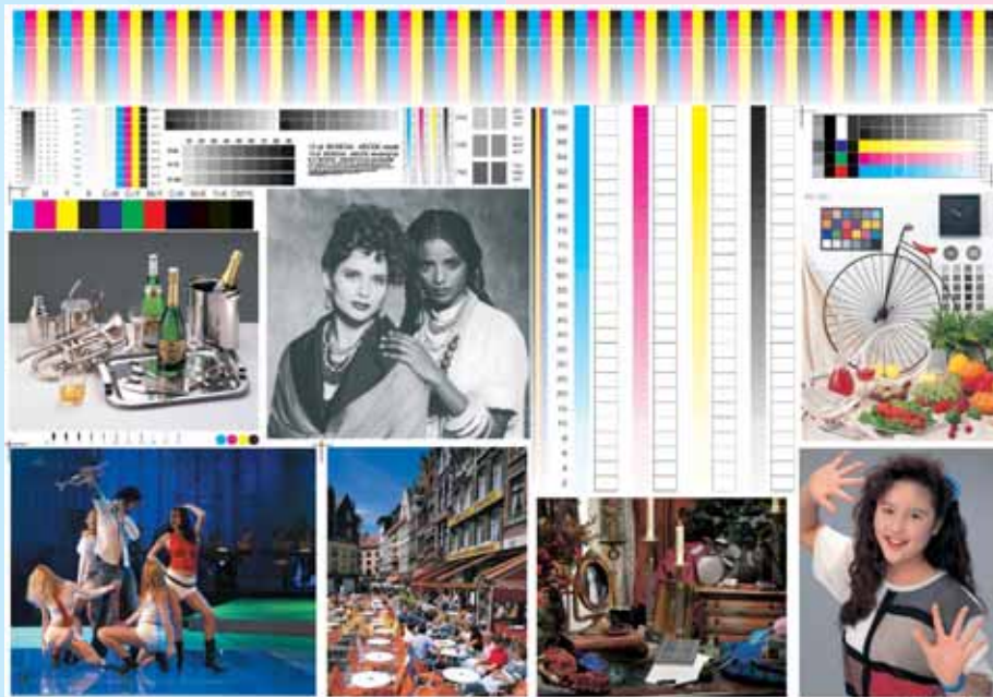
Slika 1: Testna forma, sestavljena iz različnih elementov.
