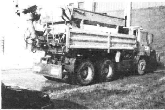
Znamenje, da krški cestni vzdrževalci mislijo na prihodnost, so naložbe v opremo. V Cestnem podjetju so nabavili vozilo Kupper, enega od sodobnejših univerzalnih posipalcev soli, kalcijevega klorida in peska, podobnega imajo tudi v Kostaku. Obe vozili še pripravljajo za uporabo. (Foto: Pilič)
