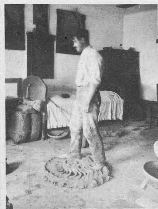
Lončar tepta glino da postane mehka in gnetljiva za oblikovanje raznih izdelkov.
