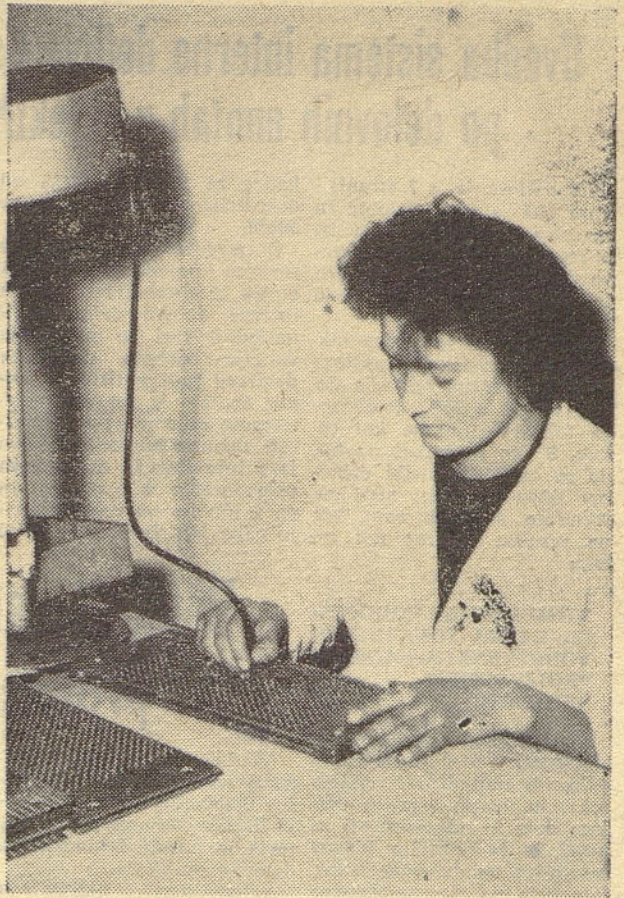
Marija Franko nalaga v obratu Sentjernej 1/4 W upora na metalizacijske letve s pomočjo dozirane naprave
