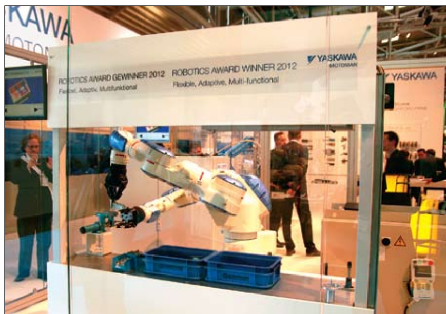
Slika 2. Yaskawin dvoročni robot pri resničnem sestavljanju vrtljivega kolesa za vozičke
