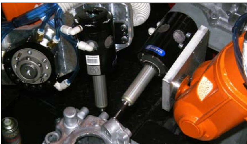
Slika 5. Robotska obdelava z rezkalnimi orodji Schunk FDB330
