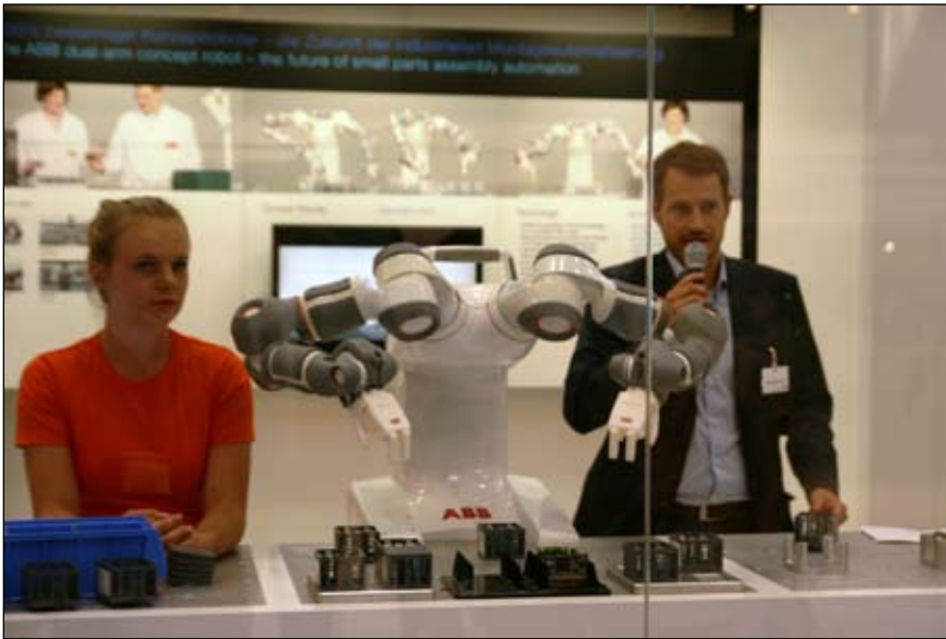
Slika 3. Zasnova dvorokega robota za namestitev na ročno delovno mesto
