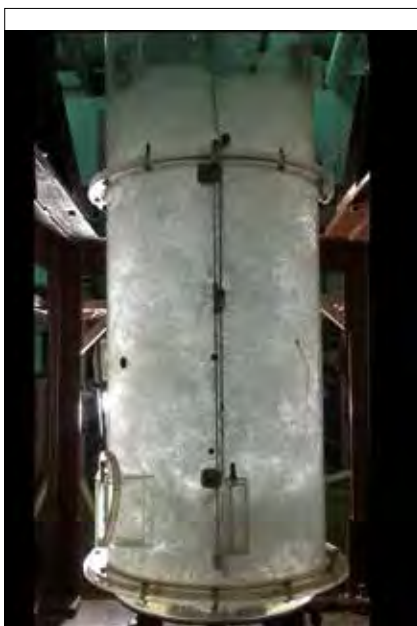
Slika 17. Dispergiranje zraka na mešalni napravi pri 178 vrt/min in pretoku zraka 28,3 m 3 /h
